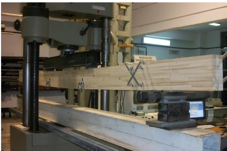
Figura 1. Viga de Populus deltoides durante el ensayo a flexión.
