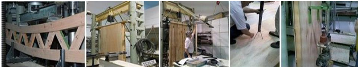
Figura 10: Ensayos UTN. Vigas – paneles de muro – compresión - choque
