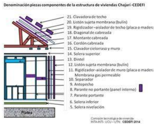
Figura 5: Esquema de denominación de piezas y calidades en viviendas del CEDEFI
