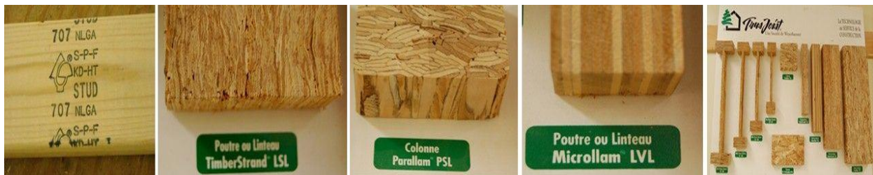
Figura 2: Productos en Canadá: Madera Stud SPF - LSL - PSL - LVL - Vigas I beam
