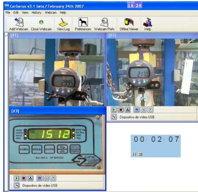
Figura 2: Pantalla de lectura de cargas y deformaciones
