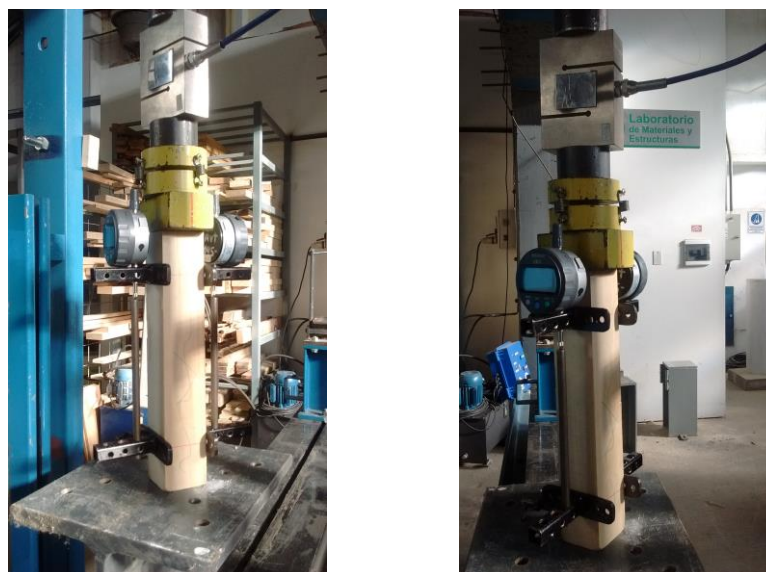
Figura 1: probeta en posición de ensayo
