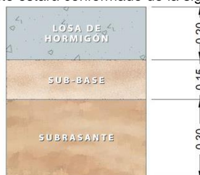
Figura 5-32 | Composición de paquete estructural.
