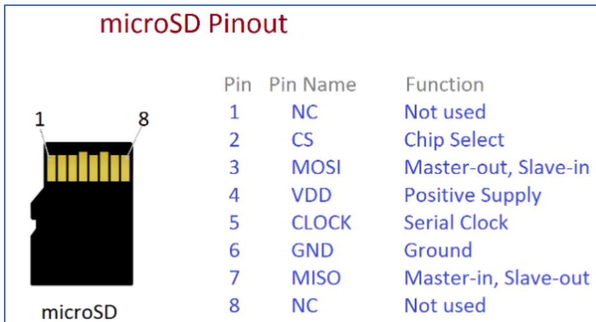
Fig. 11 Esquema de conexiones Micro SD
