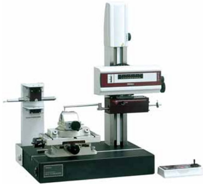
Figura 1- 1. Palpador comercial Mitutoyo “Contracer CV-1000”.
