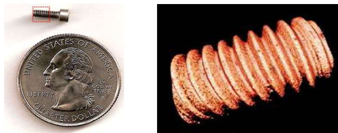
Figura 1- 15. Tornillo al que se le realizó un barrido superficial de los filetes. Superficie determinada por LCI.
