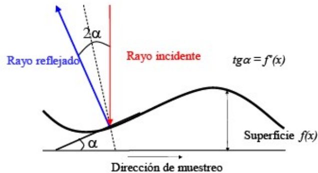
Figura 1- 7. Principio fundamental de la deflectometría óptica.
