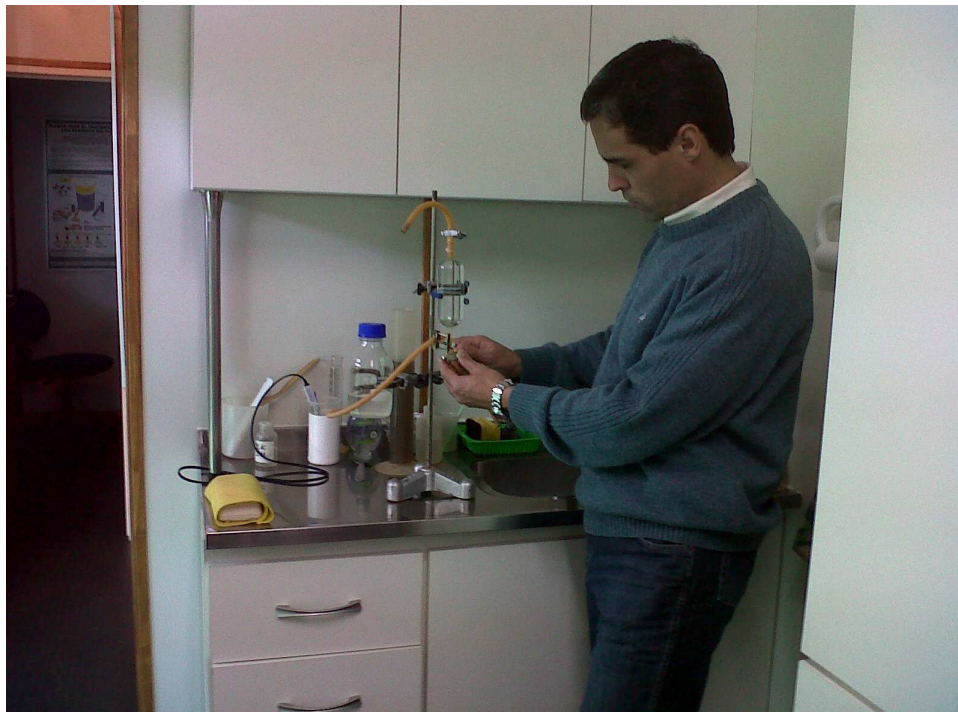
Foto 1 – Sistema de medición metano en biogás (en el laboratorio de E. Groppelli, Santa Fe)
