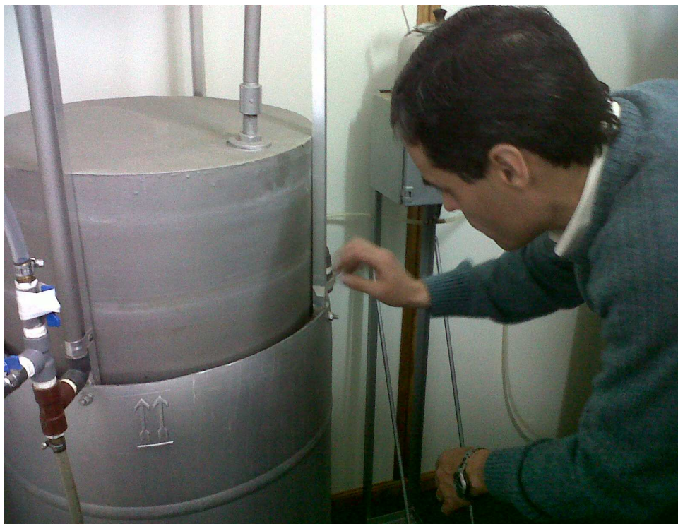
Foto 3 – Gasómetro perteneciente al biodigestor piloto nº 2 (en el laboratorio de E. Groppelli, Santa Fe)
