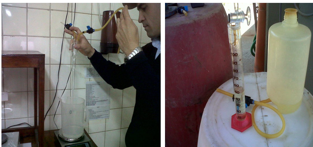
Foto 10 – Experiencia n°3 para determinar porcentaje de metano en biogás.
