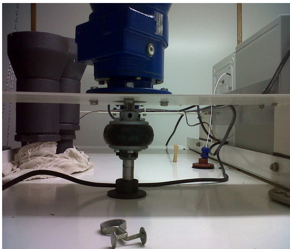
Foto 4 – Motorreductor perteneciente al biodigestor piloto nº 2 (en el laboratorio de E. Groppelli, Santa Fe)
