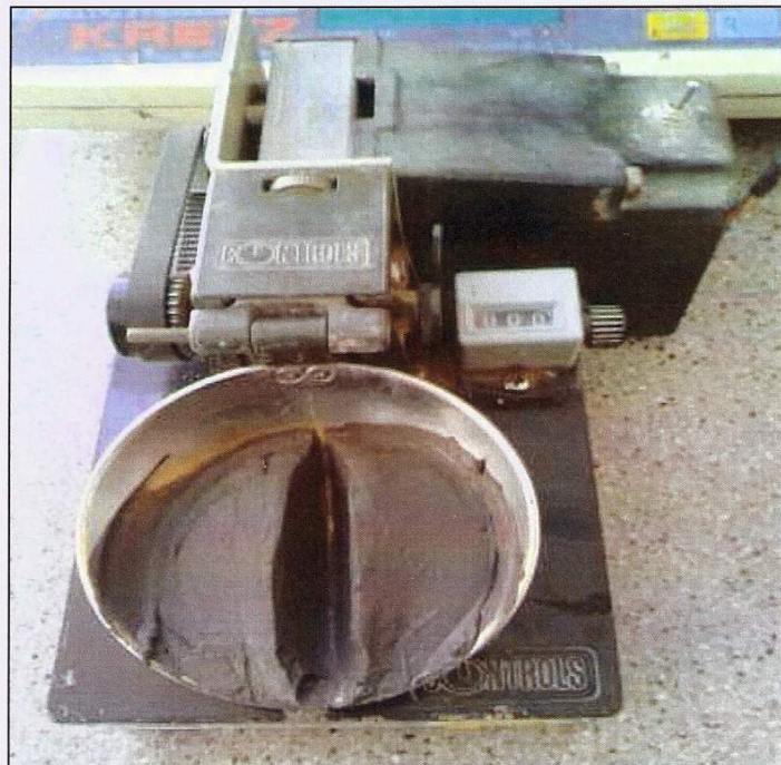
Imagen 28. Cascador de Casagrande eléctrico con contador.
