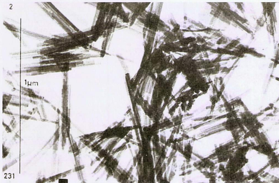
Imagen 6: Microfotografía de la Sepiolita
