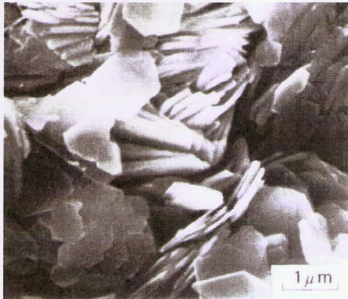
Imagen 1 Microfotografía de Caolinita
