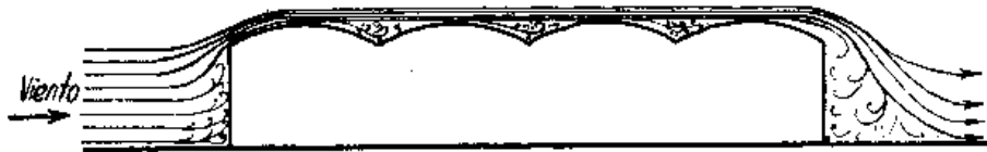
Fig. N° (8-1) - 4 Trayectorias de los filetes de una corriente de aire y zonas de turbulencias en un modelo de hangar.
