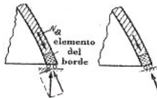
Fig. N° (6-3) - 3 Dependencia del equilibrio de las fuerzas membranales con las condiciones de apoyo de una cáscara
