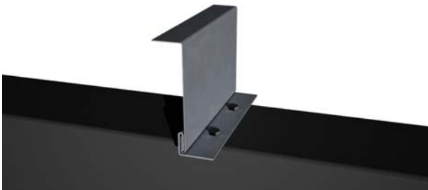
Ilustración 19 – Clips para fijar las chapas BK 460
