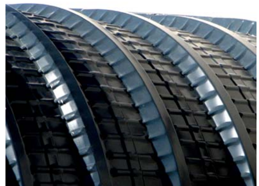
Ilustración 8 – Chapa BC 35 curvada mediante pliegues transversales en forma convexa.
