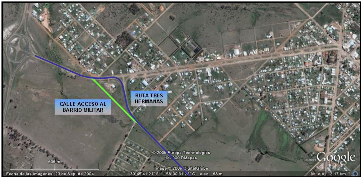
Figura IV-22 - Desvío del tránsito de Ruta Tres Hermanas por calle de acceso al Barrio Militar
