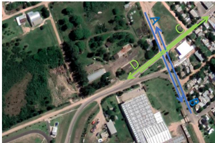
Ilustración 5.4 | Sentido de conteo de vehículos en la intersección de Cabo Pereyra y San Martín
