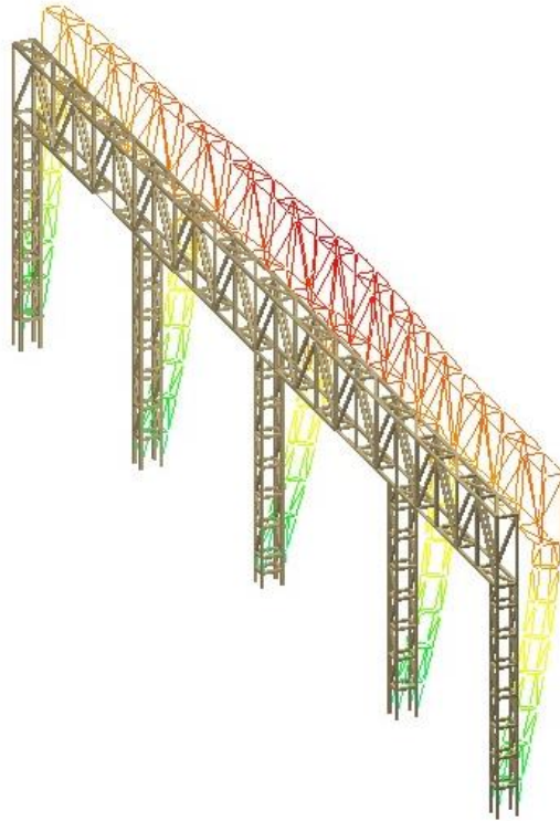
Ilustración 7.26 | Deformación total del pórtico extremo
