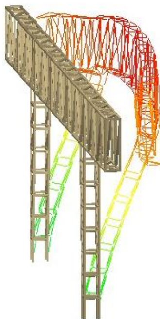
Ilustración 7.19 | Deformación total del pórtico intermedio
