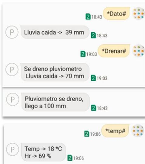
**Fig.18** "Prueba realizada enviado mensajes y mensaje recibido cuando se dreña automáticamente"
