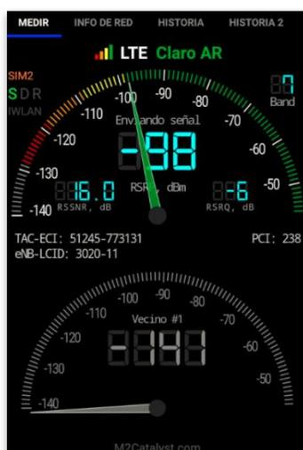
**Fig.35** "Imagen de Software utilizado, nivel de señal"
