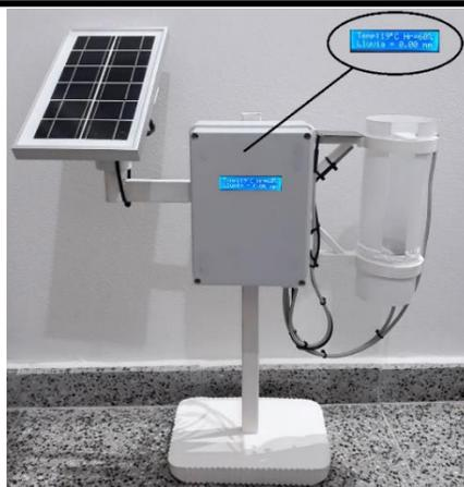
**Fig.30** "Pluviómetro sin agua, indicando 0.00mm"
