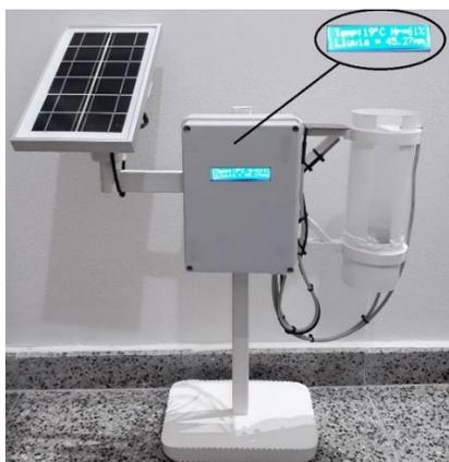
**Fig.31** "Pluviómetro con agua, indicando 45.27 mm"
