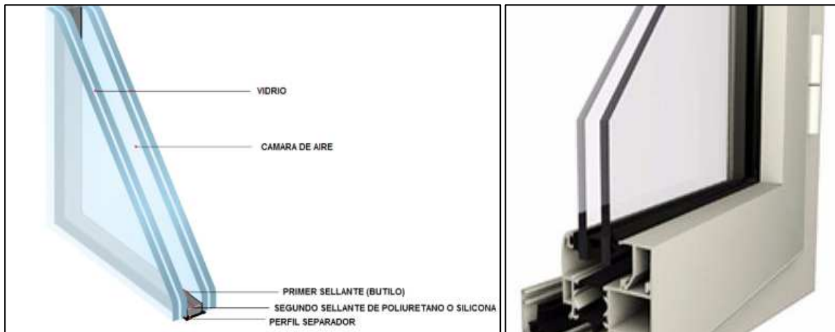
Figura 5.42 – Vidrio con doble cierre hermético. Fuente: Muborglass.
