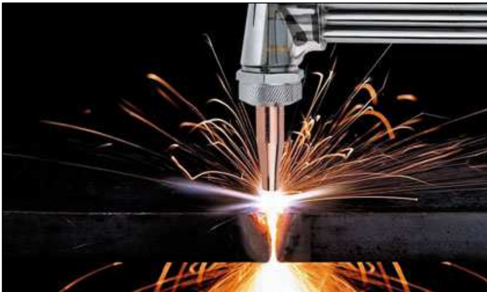
Figura 6.74 – Soldadura de corte por plasma. Fuente: Metaldio Web.
