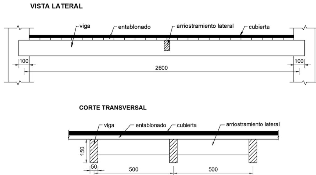
Figura 04. Esquema estructural del ejemplo M.4.E.1. Figura extraída del Manual
