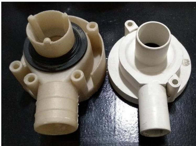
*Fig. N° 31: Bombas de agua (parte plástica)*
