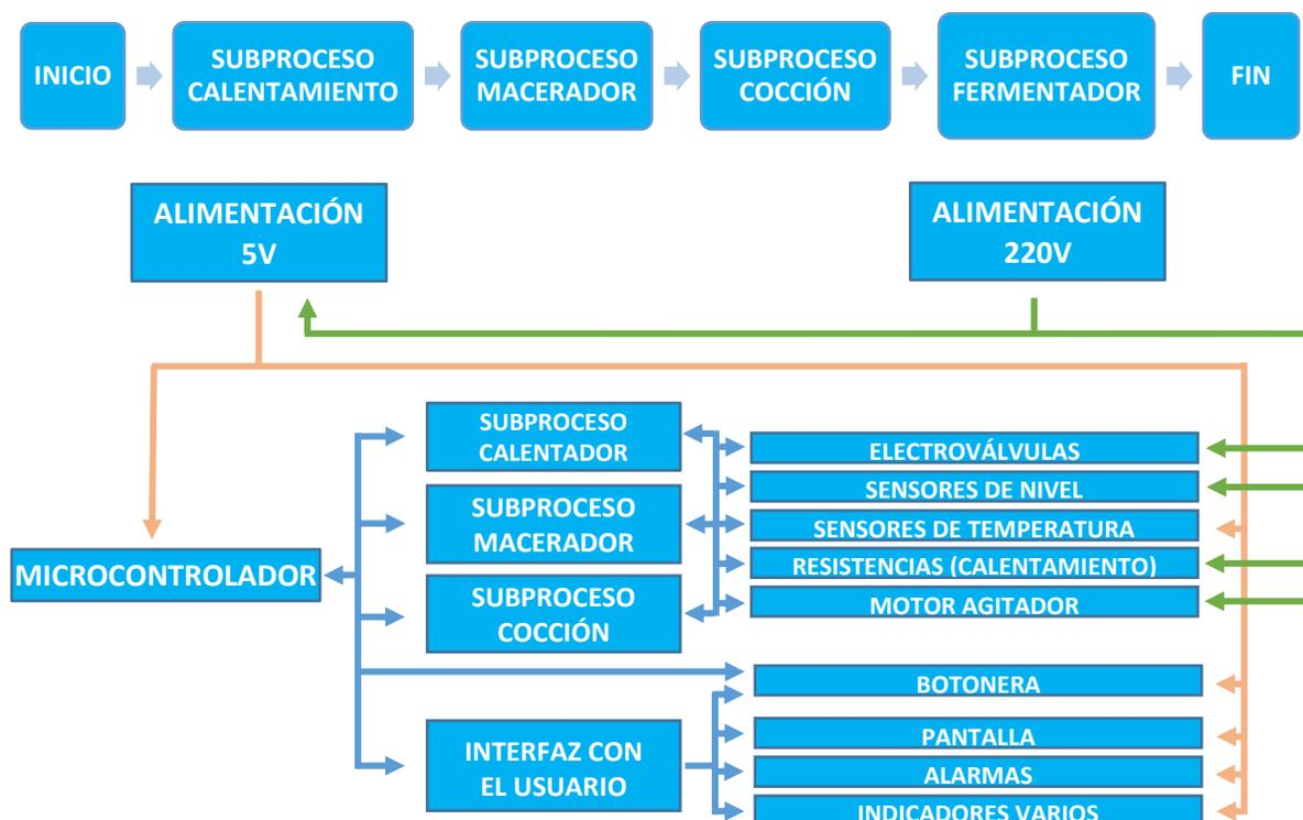
Fig. N° 1: Diagrama de procesos resumido y detallado
