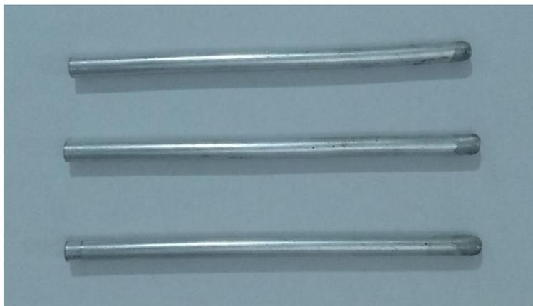
*Fig. N° 27: Varillas huecas de aluminio*
