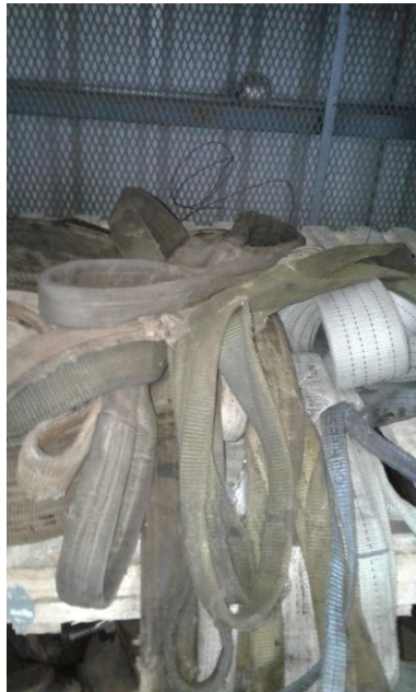
Fajas en mal estado
