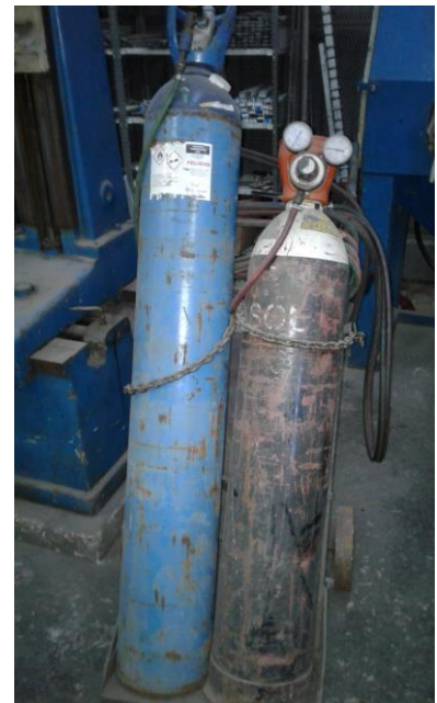
Carro porta tubos para traslado con sujeción de cadenas
