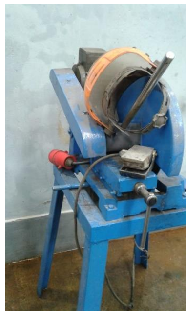
Sensitiva con protecciones mecánicas y EPP para su uso
