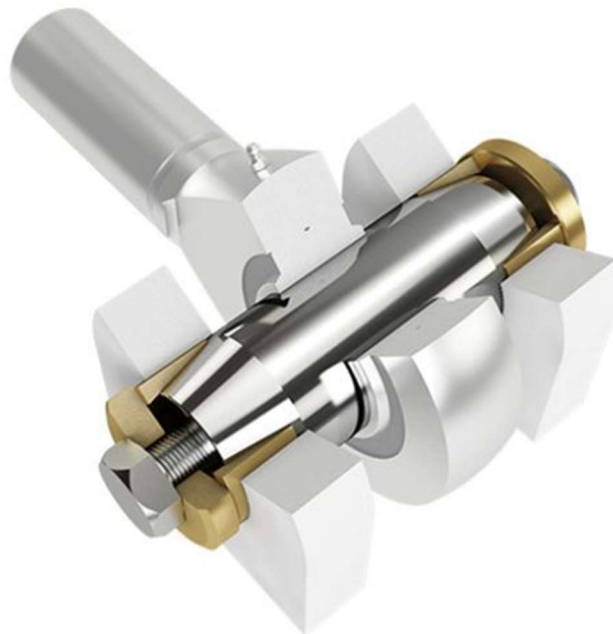
Figura 3-19 Cojinete de pasador con tornillo y arandela expansora. Proporciona un sistema de auto ajuste.
