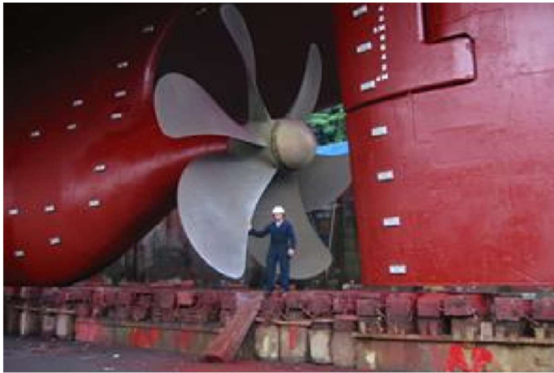
Figura 8-1 Ánodos de Zinc.
