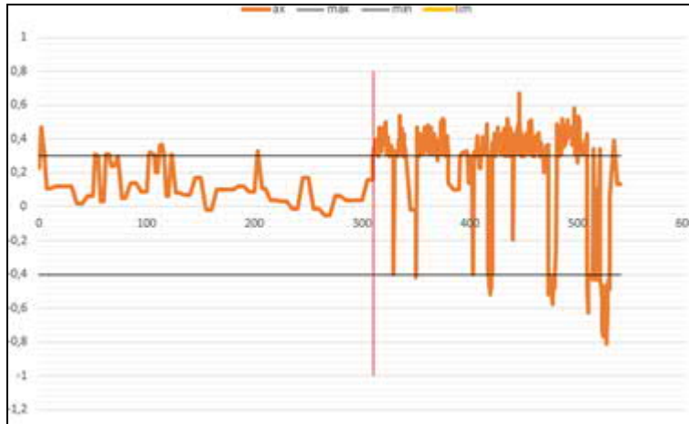
Fig. 23. Procesamiento de datos recolectados durante una prueba piloto en campo, patrón de aceleraciones y frenadas bruscas (separadas por línea vertical roja).
