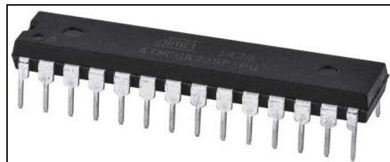
Fig. 3. Microcontrolador ATmega328 – Encapsulado PDIP.
