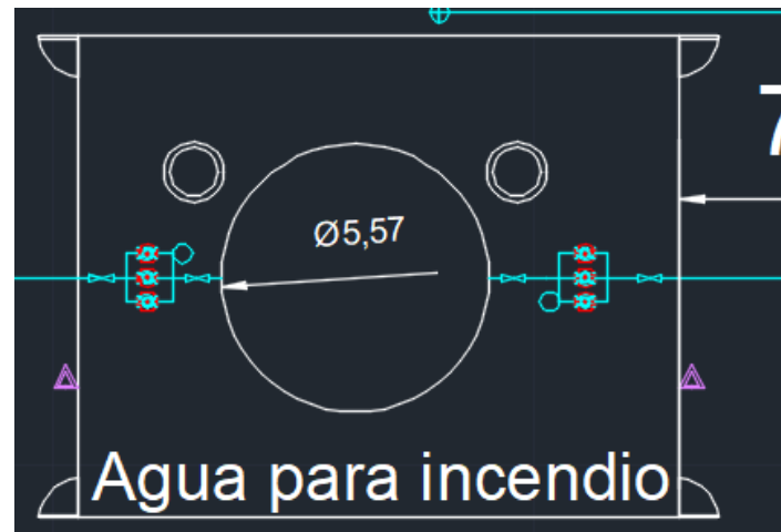
Figura 8. Tanque de agua y sistemas de bombeo en el layout de planta.
