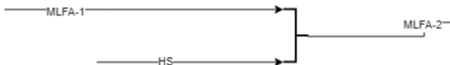
Figura 7. Agregado de la solución de soda cáustica a la corriente de proceso.
