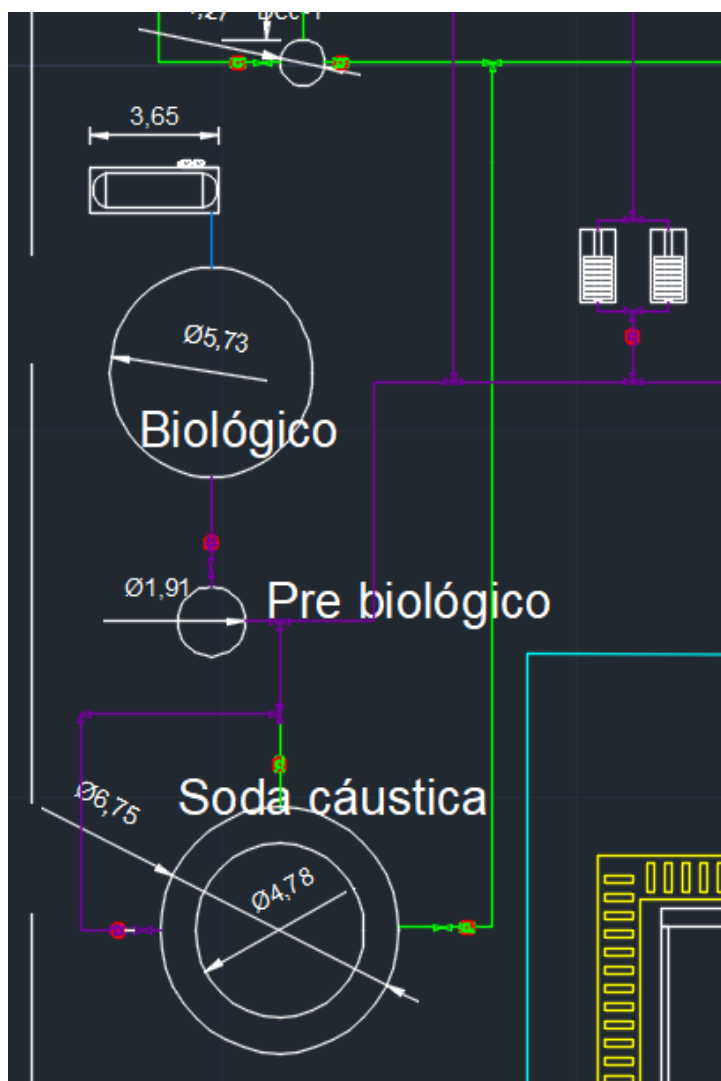
Figura 12. Tanques de soda y de tratamientos, con sus diámetros.
