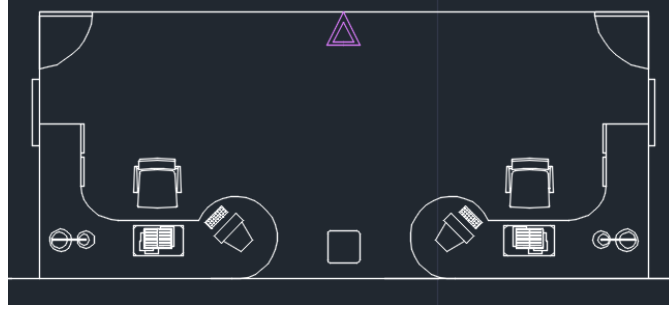
Figura 21. Instalación de matafuegos para las oficinas de vigilancia.
