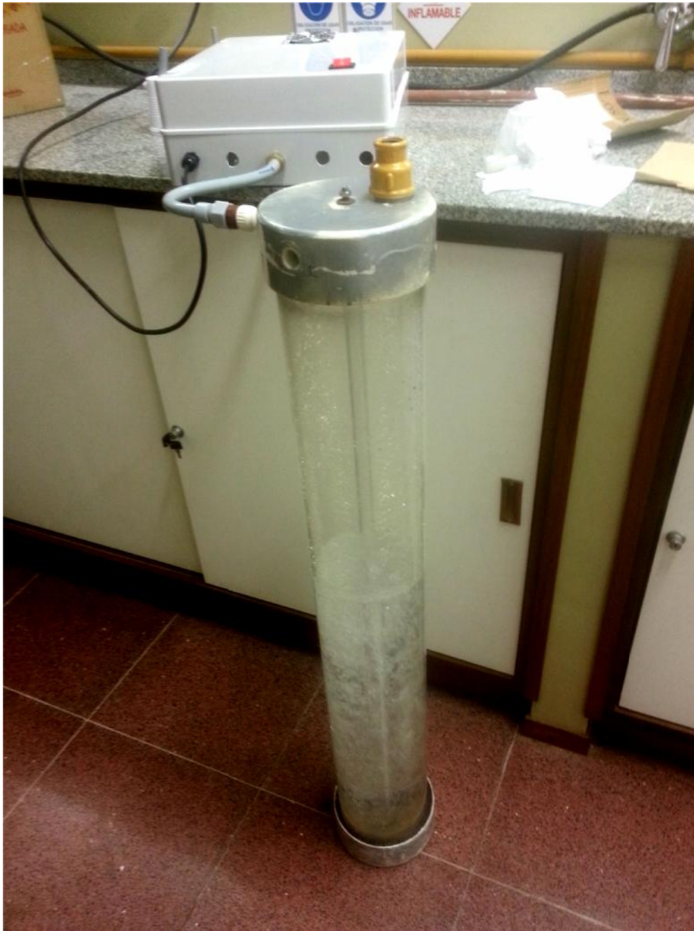
Figura 5: Cámara de contacto
