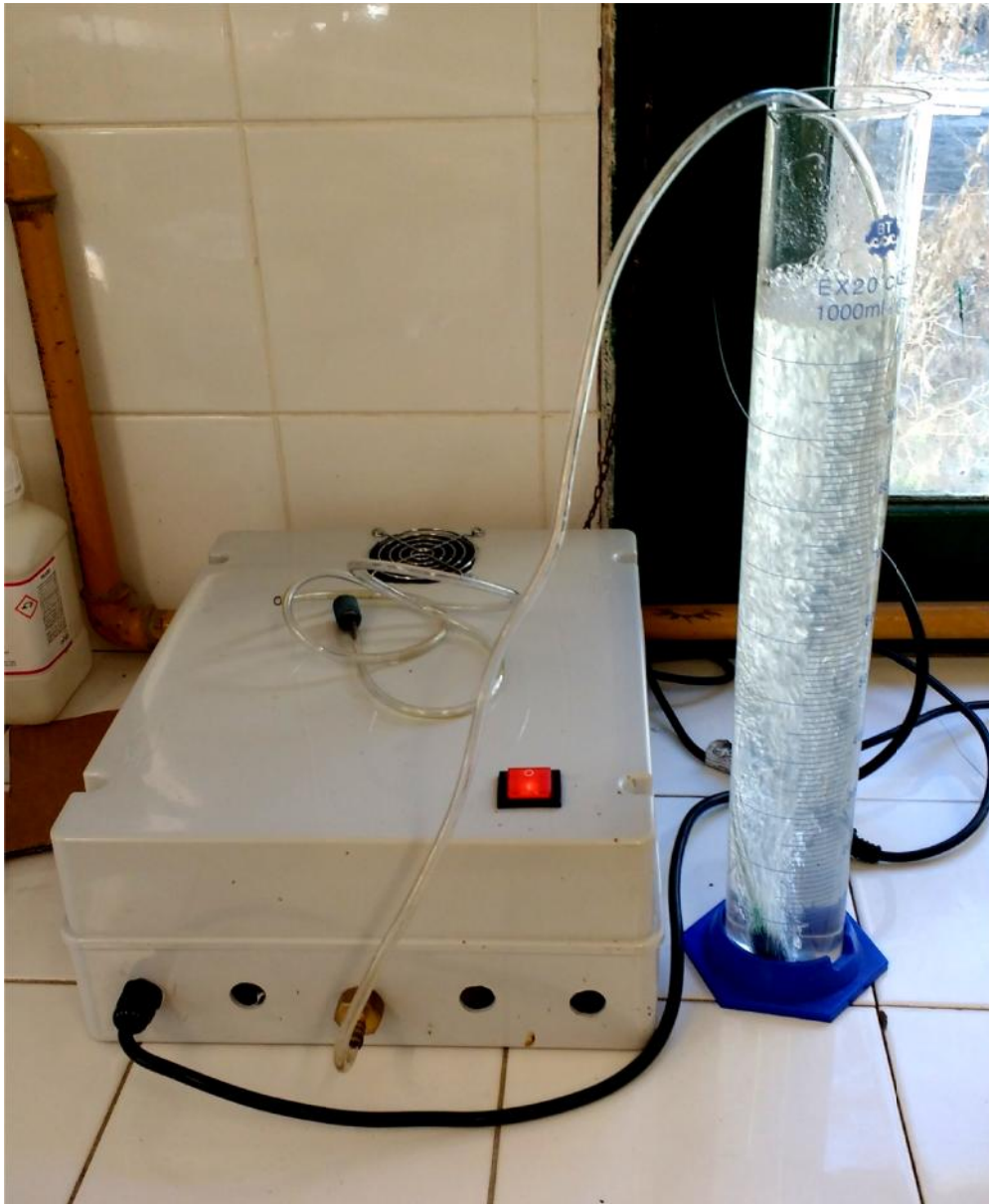
Figura 6: Probeta usada como cámara de contacto
