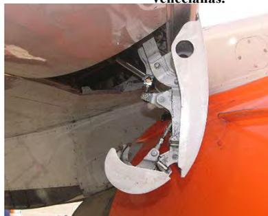
Figura 5: Flaps de Borde Ataque Krüger se acciona automáticamente cuando se despliega el Flap de B.F, 1° o más
