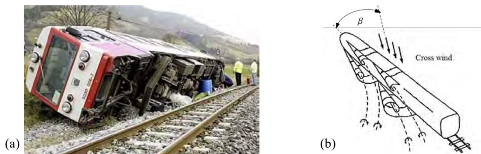
**Figura 1 – Accidente relacionado con el viento cruzado [1] y estructuras vorticosas para  $\beta > 10^\circ$  [2].**
