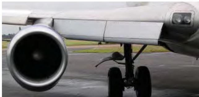
Figura 6: Flaps de Borde de Ataque Krüger. Son dos secciones por semi ala se acciona automáticamente cuando se despliega el Flap de B.F, 1° o más
