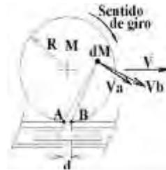
Se analiza una rueda un instante antes y un instante inmediatamente después de pasar la discontinuidad. La distribución de los vectores velocidad en la rueda cambia abruptamente de dirección, al tener antes y después de la discontinuidad, distintos centros instantáneos de rotación, por lo cual habrá una variación de la energía cinética.
