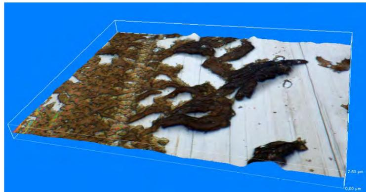
Figura 6 - Topografía tridimensional de una sección del film transferido, obtenida por stacking confocal (100×).
