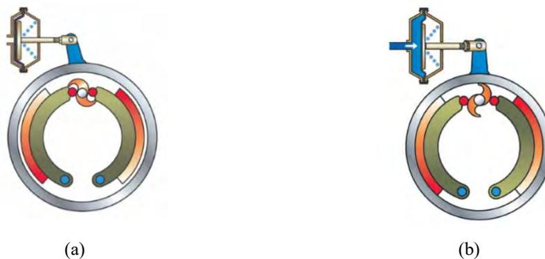
Figura 2- (a) Freno S-cam liberado ; (b) Freno S-cam aplicado
