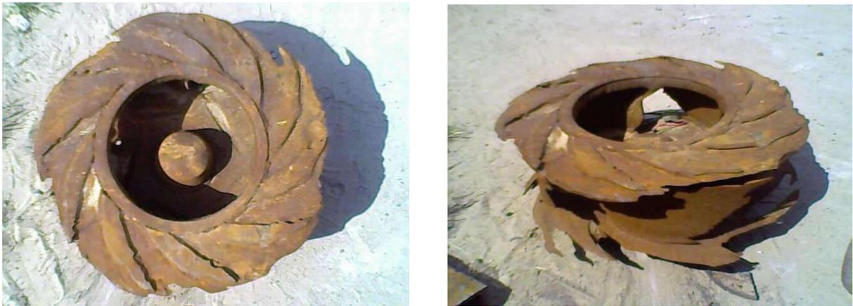
**Figura 7 – (a) Rotor de bomba 12”-12” desgastado luego de 2 años de uso; (b) Otra vista del mismo rotor.**
