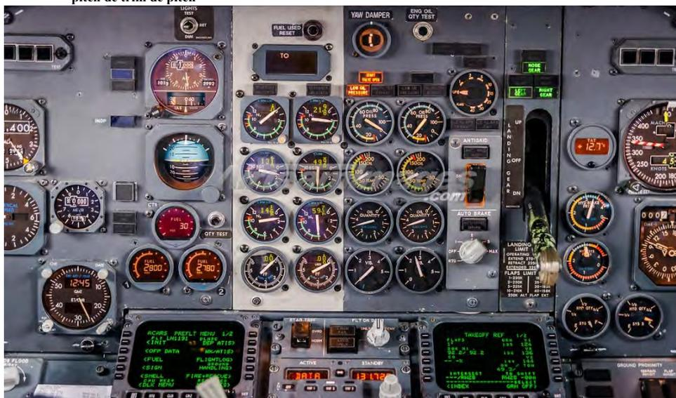
Figura 12: Vista del Panel principal de del B-737-204 C, donde puede observarse (avión gemelo del LV-WRZ) el Indicador de Flap de Borde de Fuga (T.E), y Las Luces Indicadoras de Flap de Borde de Ataque (L.E.), con las luces correspondientes a su activación automática cuando los Flap de Borde de Fuga alcanza un grado de extensión. Puede verse con mas detalles en la Figura 11.
