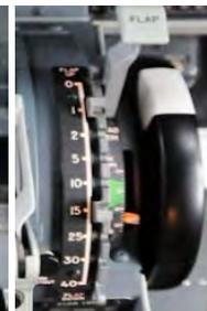
Figura 8.2: Sector ampliado. Palanca de Flaps B.F e Indicador derecho de posición de “trim de pitch”
