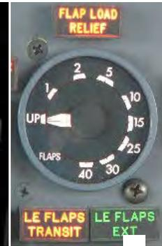
Figura 11: Indicador de posición de Flap de
