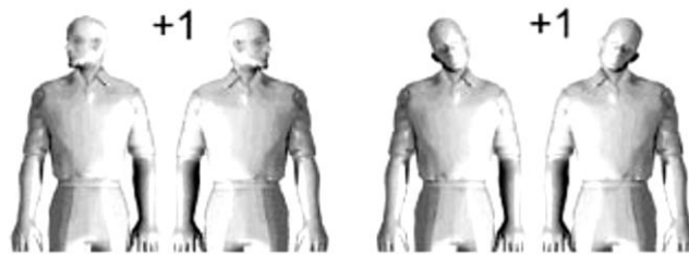
Figura N° 14 – Posiciones que modifican la puntuación del cuello Rotación e Inclinación del Cuello.
