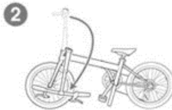
Gráfico 2: sistema de plegado común.
