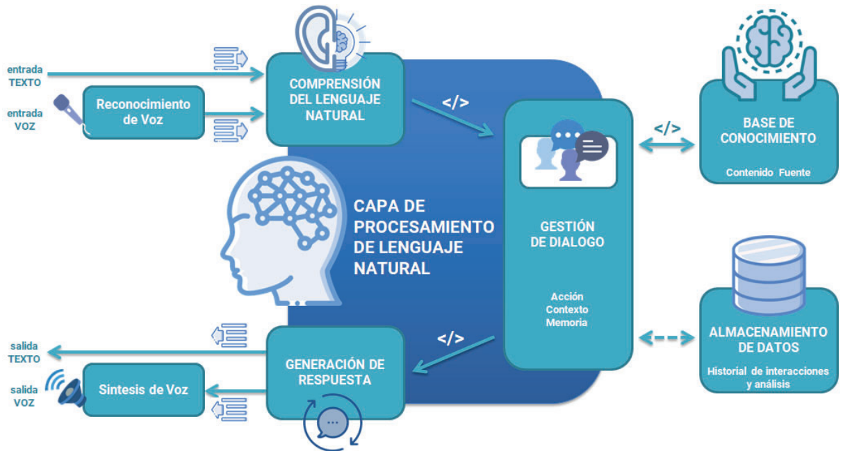
Imagen 3.2 - Diagrama de bloques de funcionamiento de un chatbot
