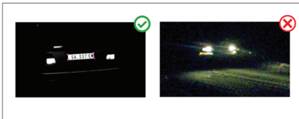
Imagen 4.9 - Utilización de luz infrarroja y filtro sobre la imagen para quitar luz de faros
