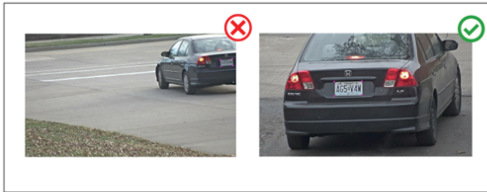
Imagen 4.11 - Mejora de lectura con ampliación de resolución de cámara
