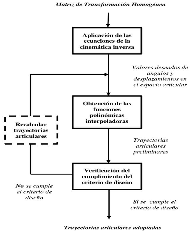
Figura 7: Método de obtención de las trayectorias articulares en el marco del módulo de control cinemático
