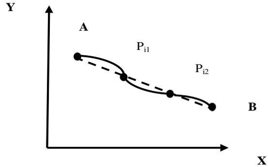
Figura 4: Trayectoria real aproximada a la trayectoria recta deseada en el espacio de trabajo
