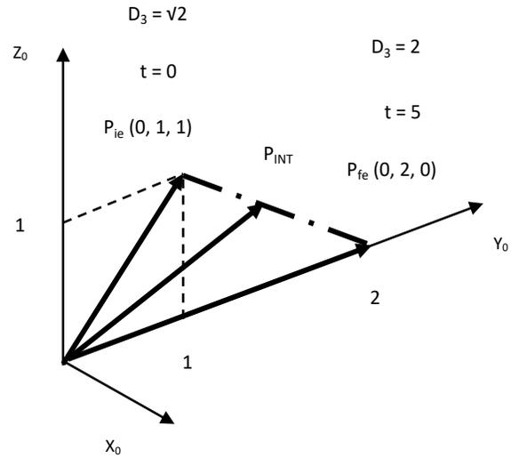
Figura 17: Trayectoria cartesiana del extremo del manipulador que pasa por los puntos  $P_{ie}$ ,  $P_{INT}$  y  $P_{fe}$  donde la longitud del manipulador varía en el tiempo según función polinómica de Ec. (15).
