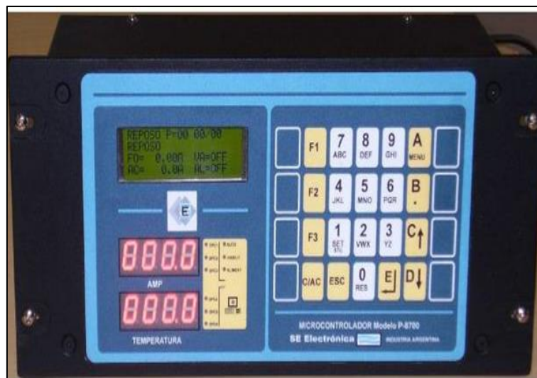
Fig. 1-30. PLC Controlador del proceso productivo
