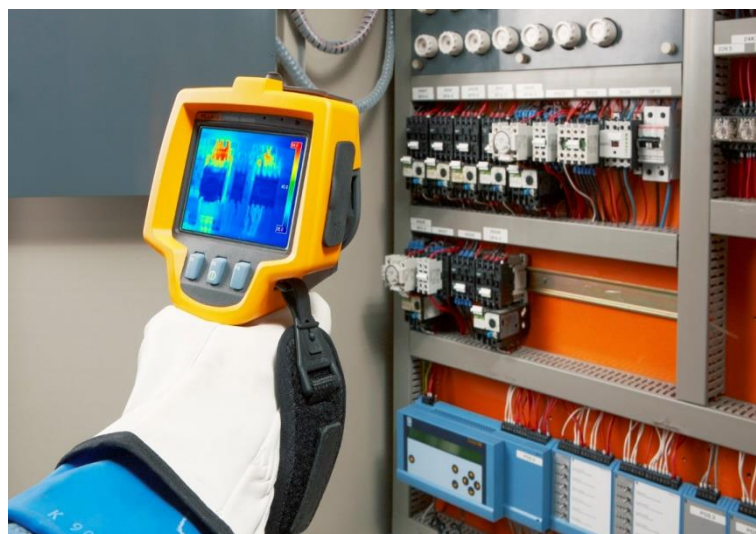
Fig. 3-39. Cámara termo gráfica e imagen radiométrica
