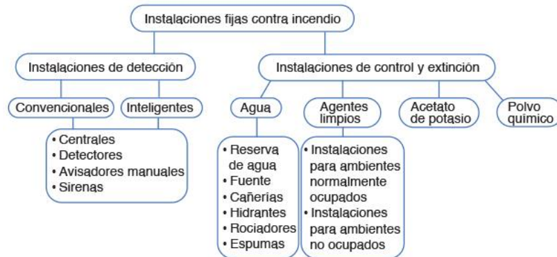
Fig. 3-21. Esquema de componentes de una instalación fija
