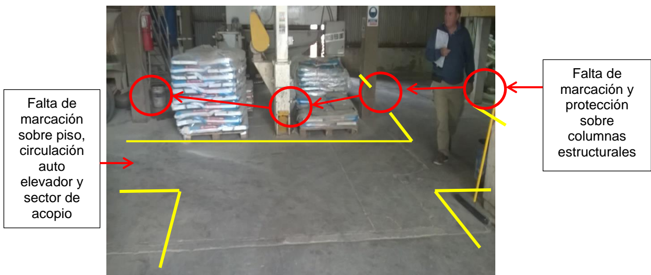
Fig.3-34. Falta de marcación sobre piso de circulaciones y lugares de acopio
