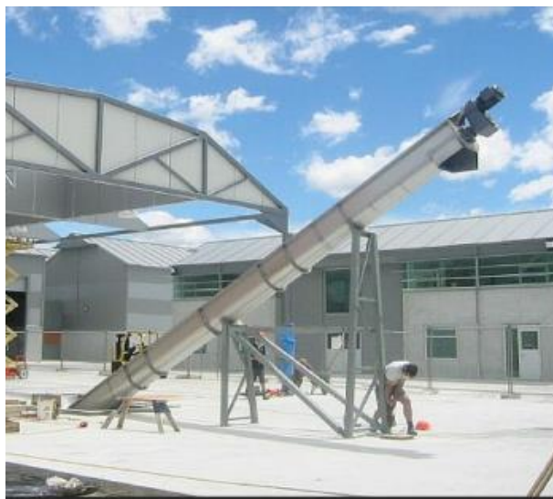
Figura 45 - Esquema ilustrativo del sinfín inclinado.
