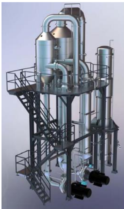
Figura 59 - Esquema ilustrativo del evaporador doble efecto adoptado.
