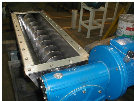
Figura 44 - Esquema ilustrativo del sinfín adoptado.
