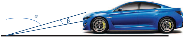
Figura 6. Fenómeno de retrorreflexión y geometría a 30 metros.
