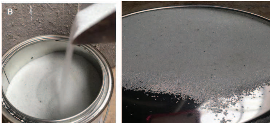
Figura 12. A: Microesferas de premezcla tipo P1; B: Microesferas tipo S2, con tratamiento TAF (tratamiento de adherencia y flotación en aplicación sobre pintura con base a solvente).
