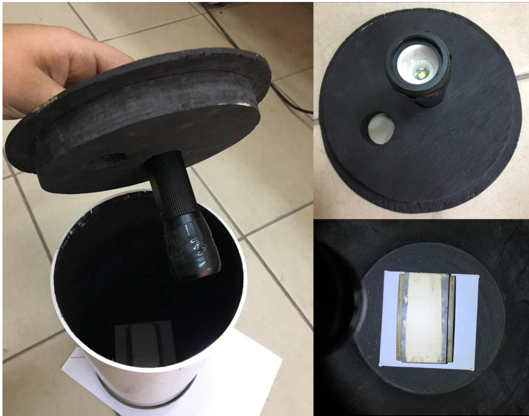
Figura 5. Cabina portátil utilizada para comparación visual
