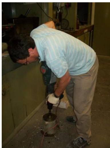
Figura 5 moldeo de probeta
