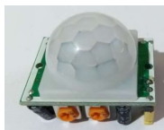
Imagen 5.10: Módulo sensor de movimiento HC SR 501 PIR (*16)
