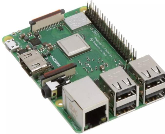
Figura 6) Computadora Raspberry Pi 3B+
