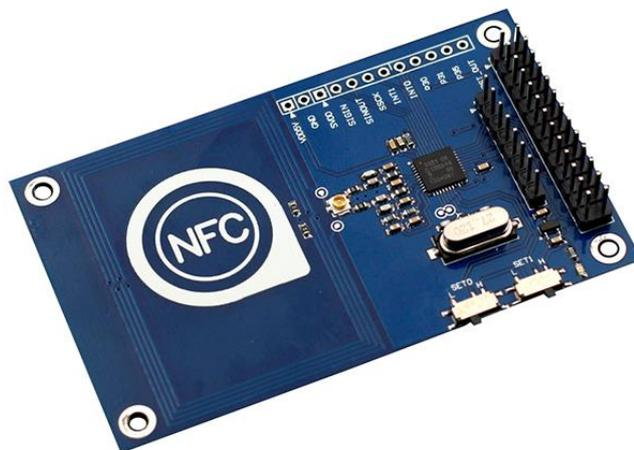
Figura 36) Módulo de interfaz NFC para RaspberryPi
