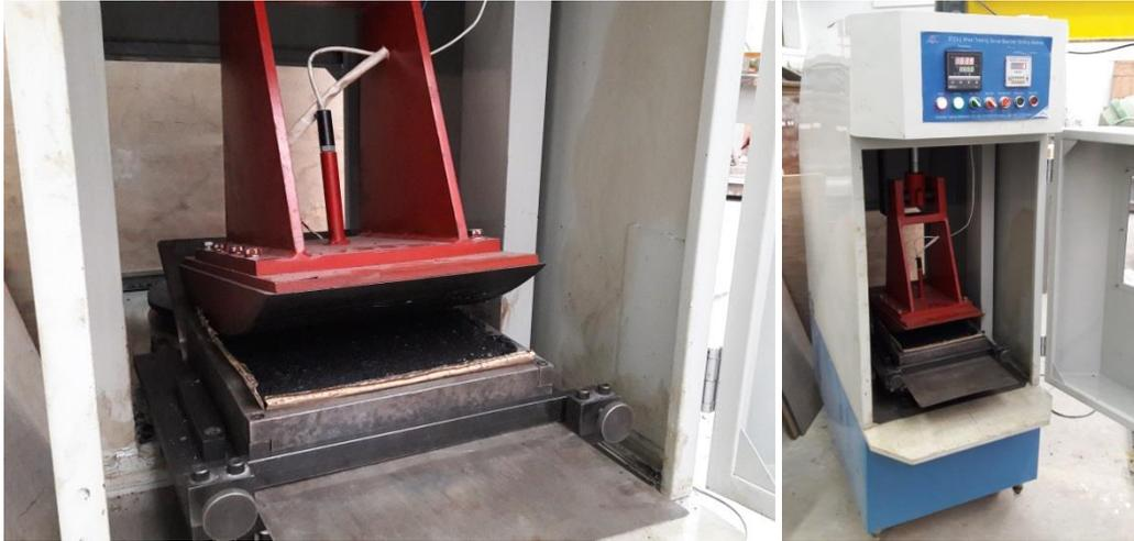
Figura 10. Moldeo de probetas con Roller Compact
