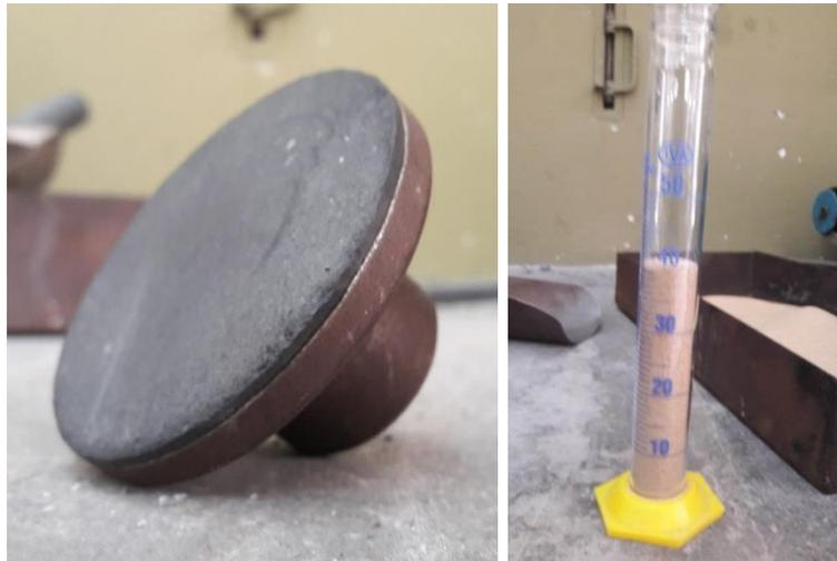
Figura 14. Detalle pisón normalizado (izq.) y preparación de volumen de ensayo (der.)
