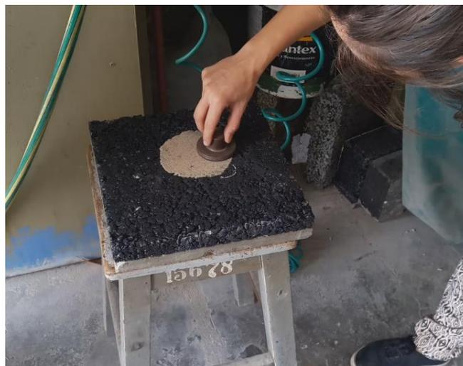
Figura 4. Realización de ensayo de parche de arena en laboratorio
