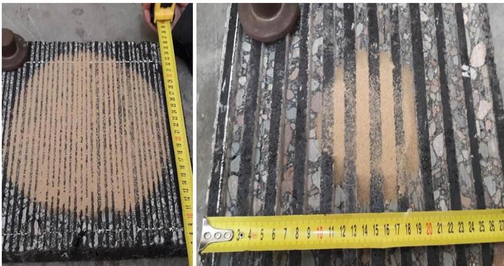
Figura 15. Parche de Arena, probeta Caso 1 (izq.) y Caso 6 (der.)
