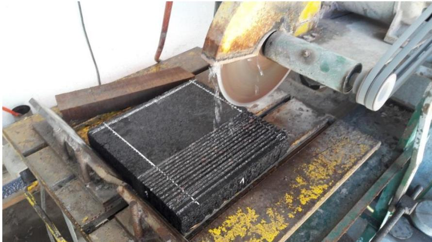
Figura 11. Simulación del fresado, probeta Caso 1
