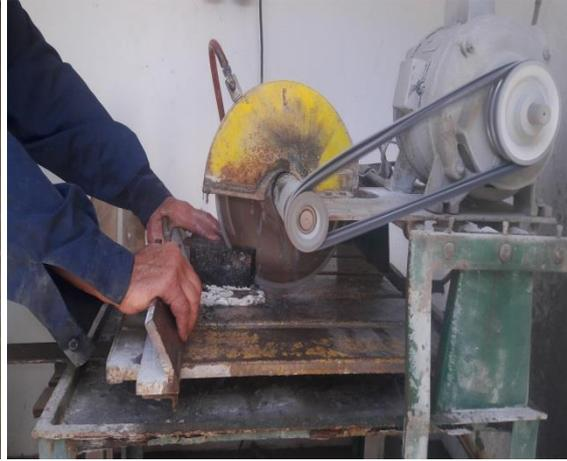
Figura 7. Aserrado de testigos
