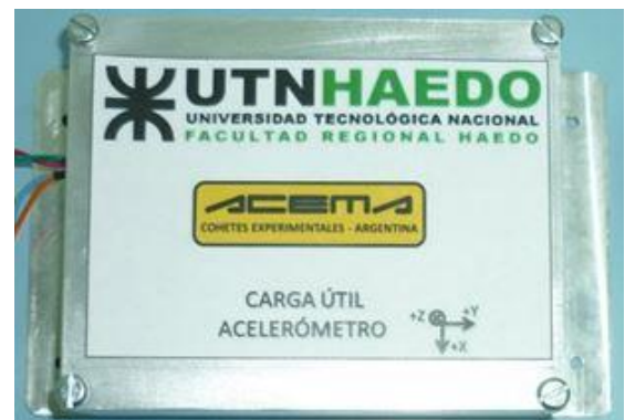
Fig. 7. Gabinete para albergar el módulo.
