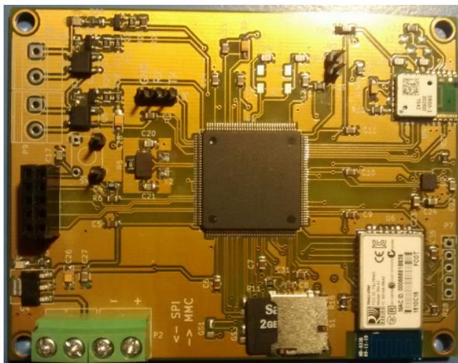
Figura 3. Fotografía del dispositivo de registro de datos
