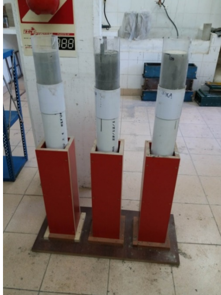
Foto 1: Tubo para ensayo de exudación
