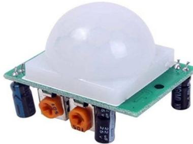
Ilustración 104: Sensor HC-SR501 de Presencia
