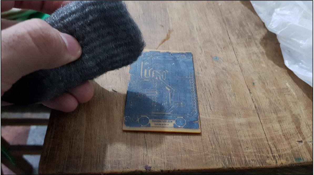
**Ilustración 122: Remover la tinta del circuito**
