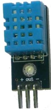
**Ilustración 102: Sensor DHT 11 de Temperatura y Humedad**
