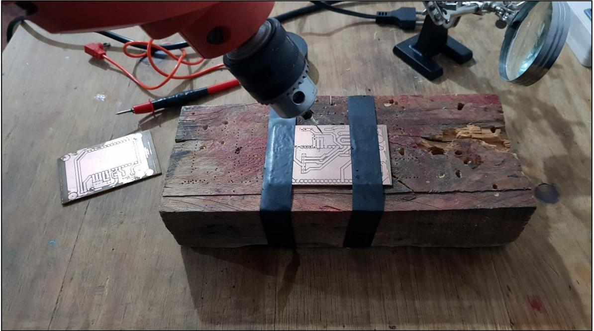
Ilustración 124: Perforación sobre la placa
