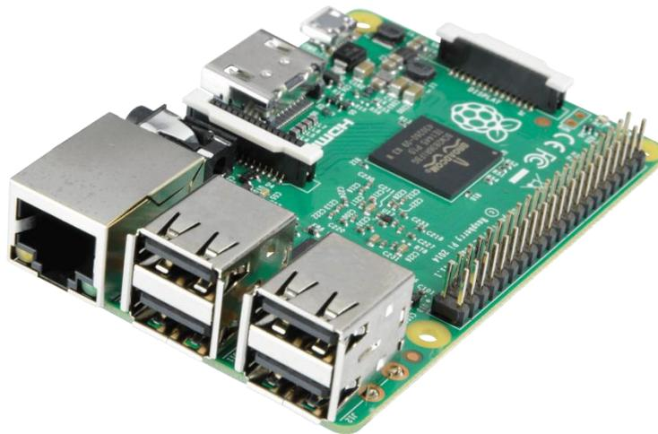
**Ilustración 97: Microcontrolador Raspberry Pi 2**
