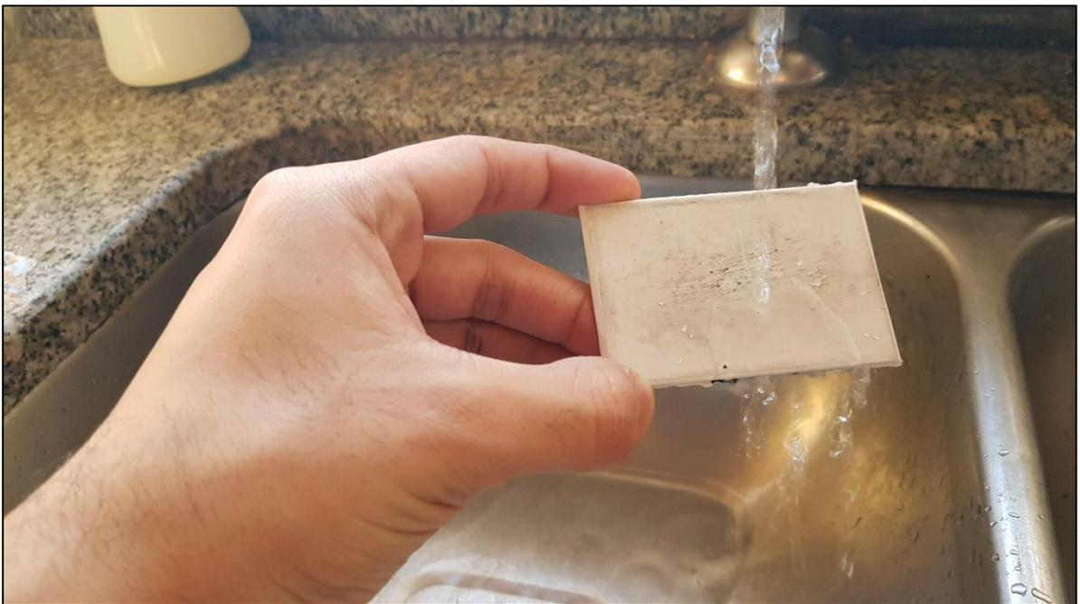
**Ilustración 119: Remover el papel mediante agua**
