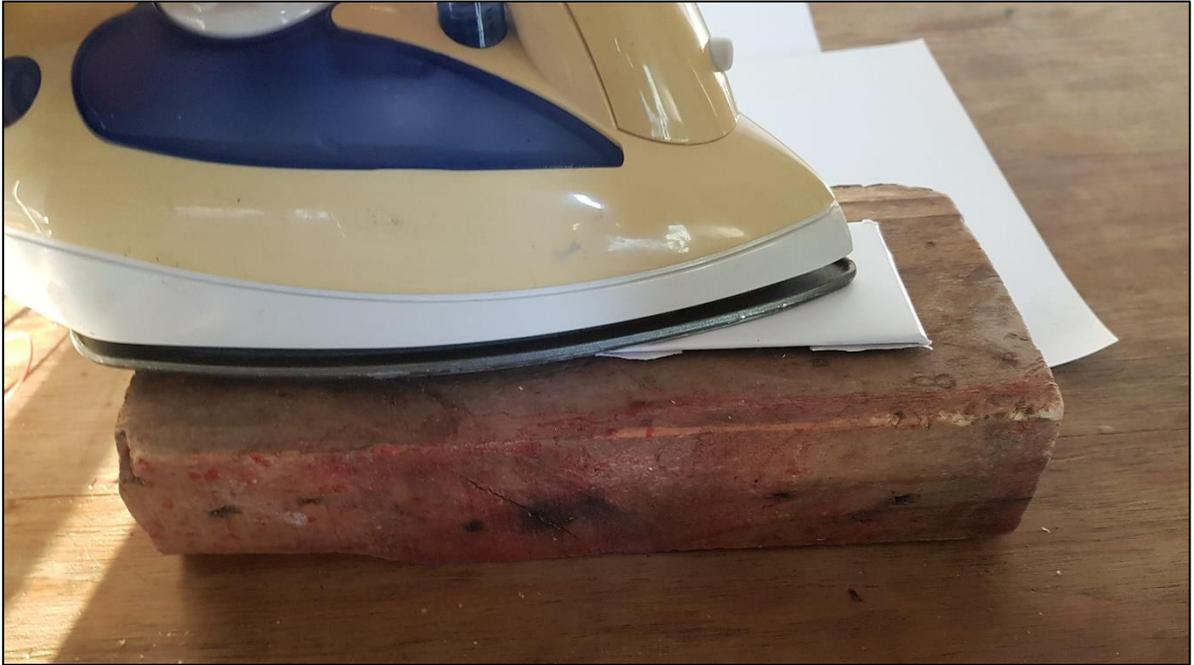
**Ilustración 118: Traspaso de la tinta sobre la placa de cobre**
