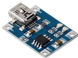
Fig. N° 7 Cargador de batería de ion de litio TP4056.
