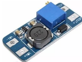
Fig. N° 8 Fuente elevadora de tensión MT3608. [17]
