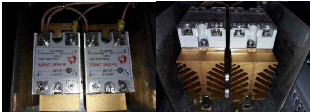
Figura 52: Relé y disipadores utilizados en este proyecto.
