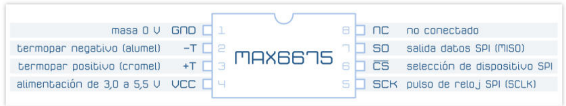
Figura 31: Patillaje del convertor analógico-digital MAX6675 para sondas termopar K con compensación de unión fría y comunicaciones SPI.
