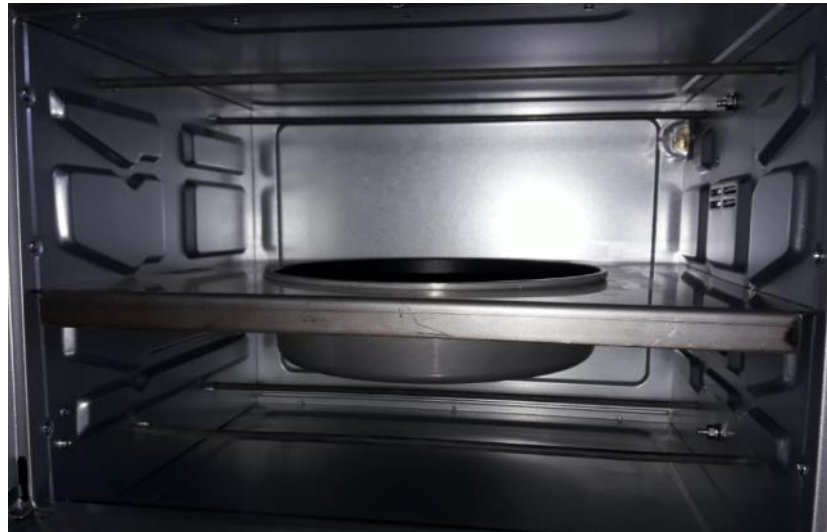
Figura 2: Detalle interior del horno con bandeja separadora y termocuplas.
