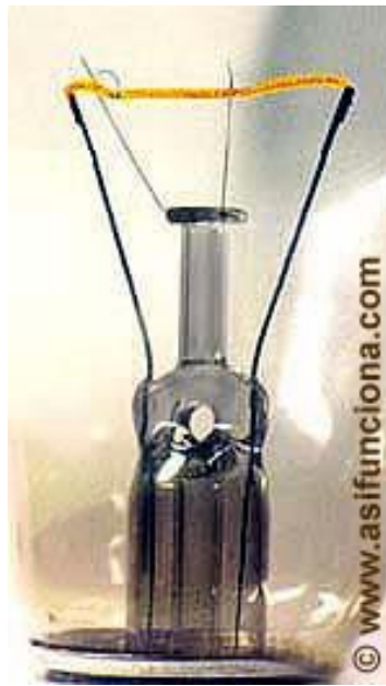
Fig. 1-39 Filamento montado en el tubo central de cristal de una lámpara incandescente. [C-39]
