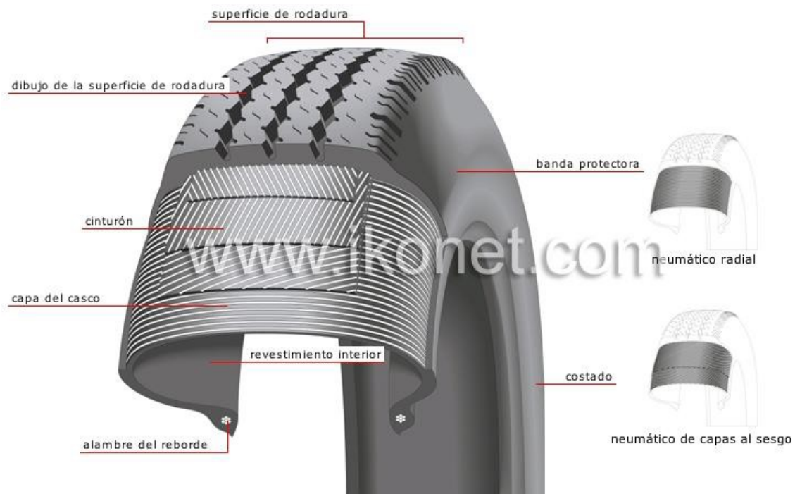
Fig. 7-40 Composición del neumático. [1-40]
