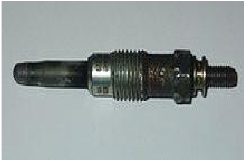
Fig. 5-10 Típica bujía de precalentamiento. Comprende de izquierda a derecha: el lápiz, el cuerpo cerámico y el borne de conexión. [J-10]
