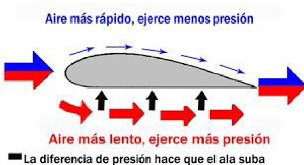
Fig. 14-8 Descripción básica de la sustentación del ala de una aeronave. [O-8]
