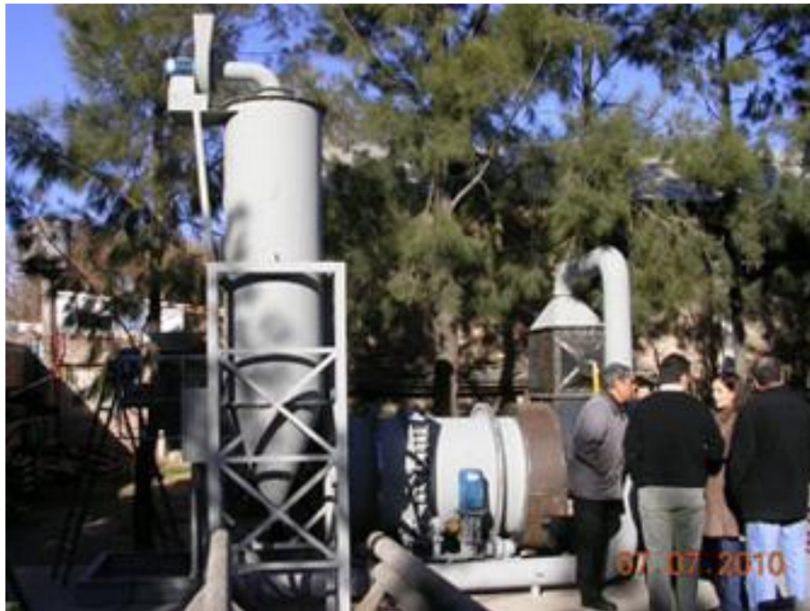
Fig. 2-22 Prototipo del horno para valorización de RSU residuos sólidos urbanos desarrollado por INTI Mendoza. [F-22]
