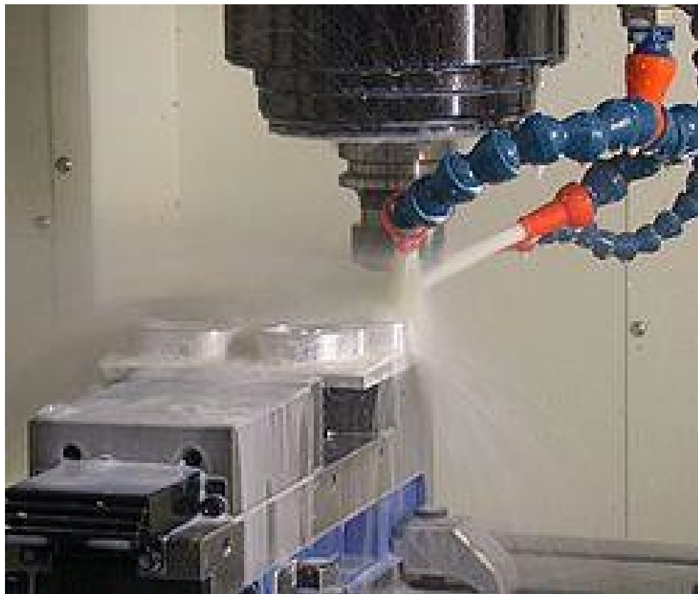
Fig. 5-5. Refrigeración del fresado CNC. [E-5]
