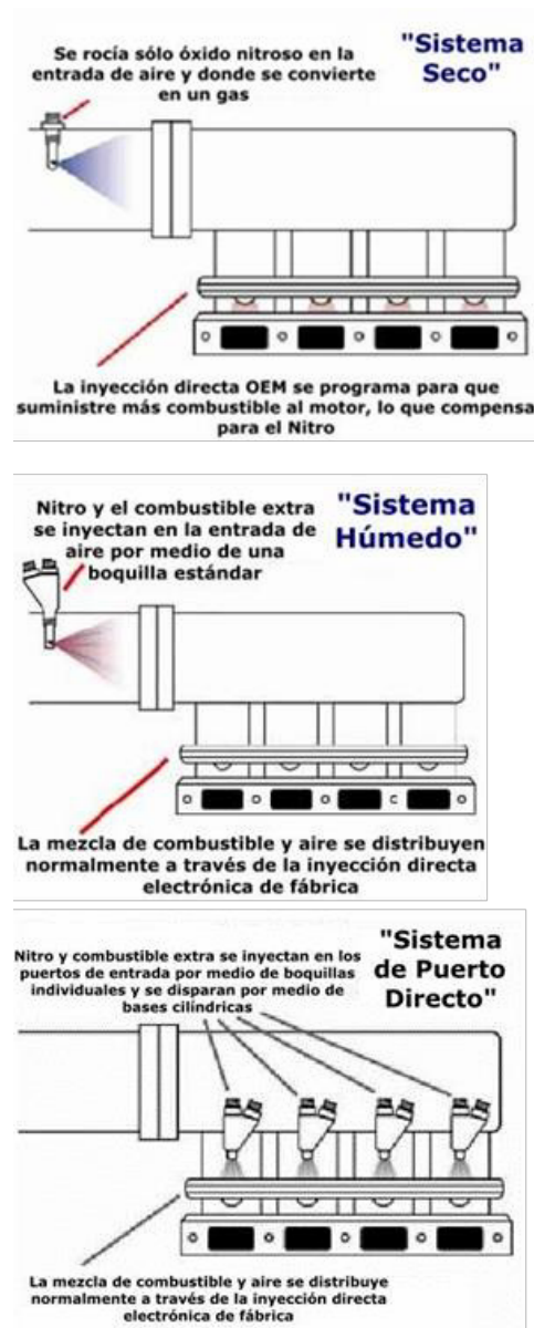
Fig. 2-38 Tipos de inyección de óxido nitroso. [E-38]
