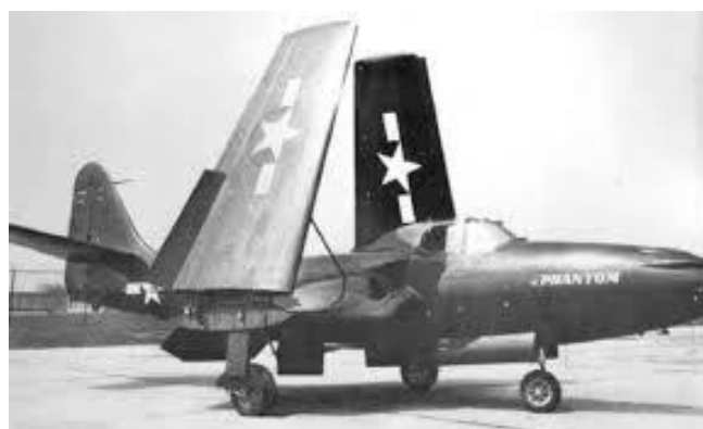
Fig. 3-15 Avión de la Segunda Guerra Mundial con alas rebatibles. [D-15]
