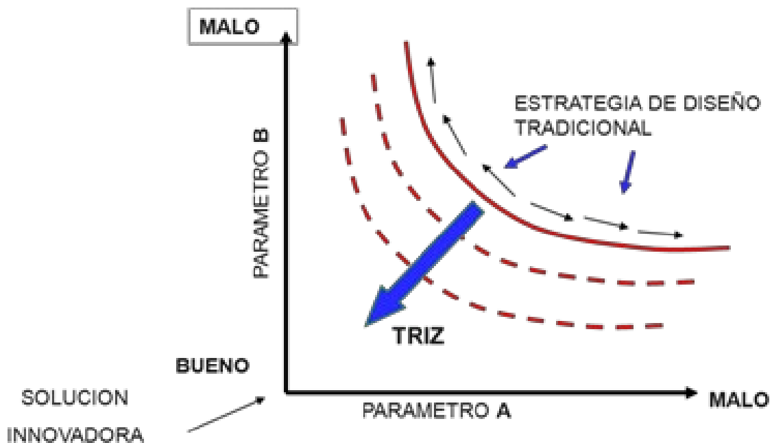
Fig. 7 La estrategia TRIZ nos lleva a no recorrer la trayectoria de la hipérbola, sino a ir directamente al origen del gráfico, donde se concentra lo bueno para ambos parámetros, es decir, no se tiene una solución de compromiso, sino que directamente se destruye la contradicción.
