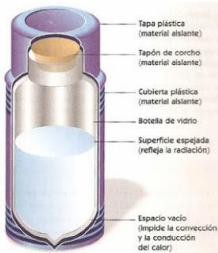
Fig. 6-40 Componentes de termo de vidrio [H-40]
