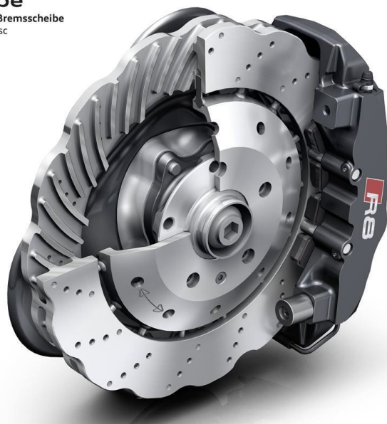
Fig. 6-31 Disco de freno hiperventilado con espacio interno y perforaciones. [I-31]
