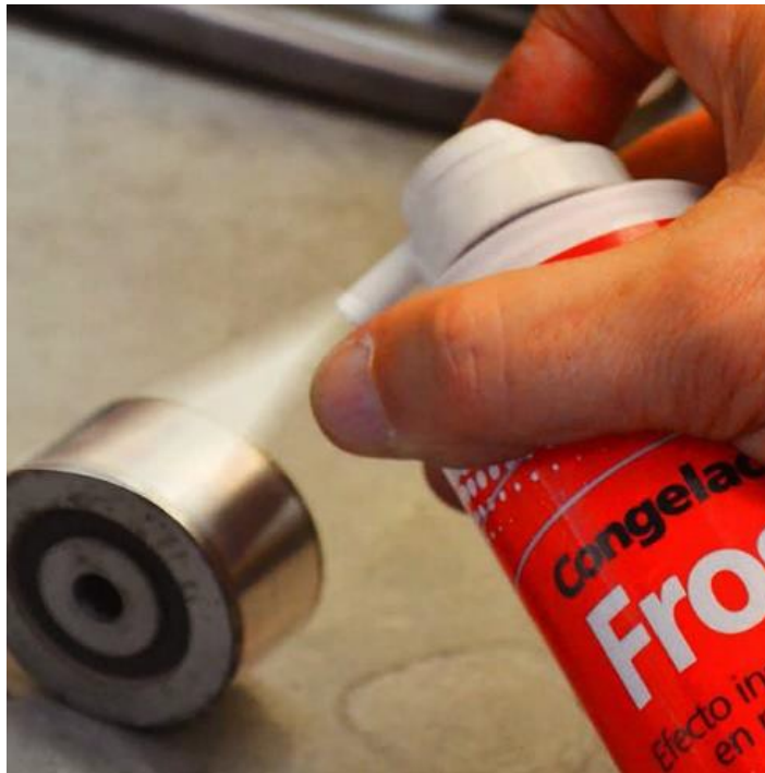
Fig. 7-13 Enfriamiento de un eje mediante un aerosol. [I-13]
