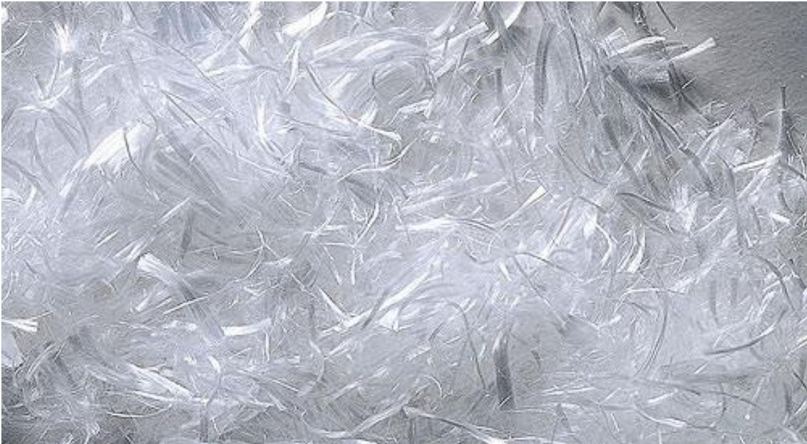
Fig. 5-39 La fibra de vidrio aumenta la rigidez, la estabilidad térmica y la conductividad dieléctrica de algunos materiales. [G-39]
