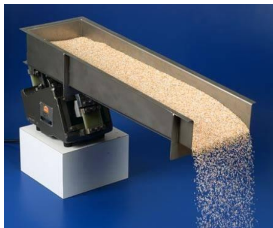
Fig. 5-18 Alimentador de polvos por vibración, el cual regula su caudal mediante la frecuencia de oscilación. [I-18]
