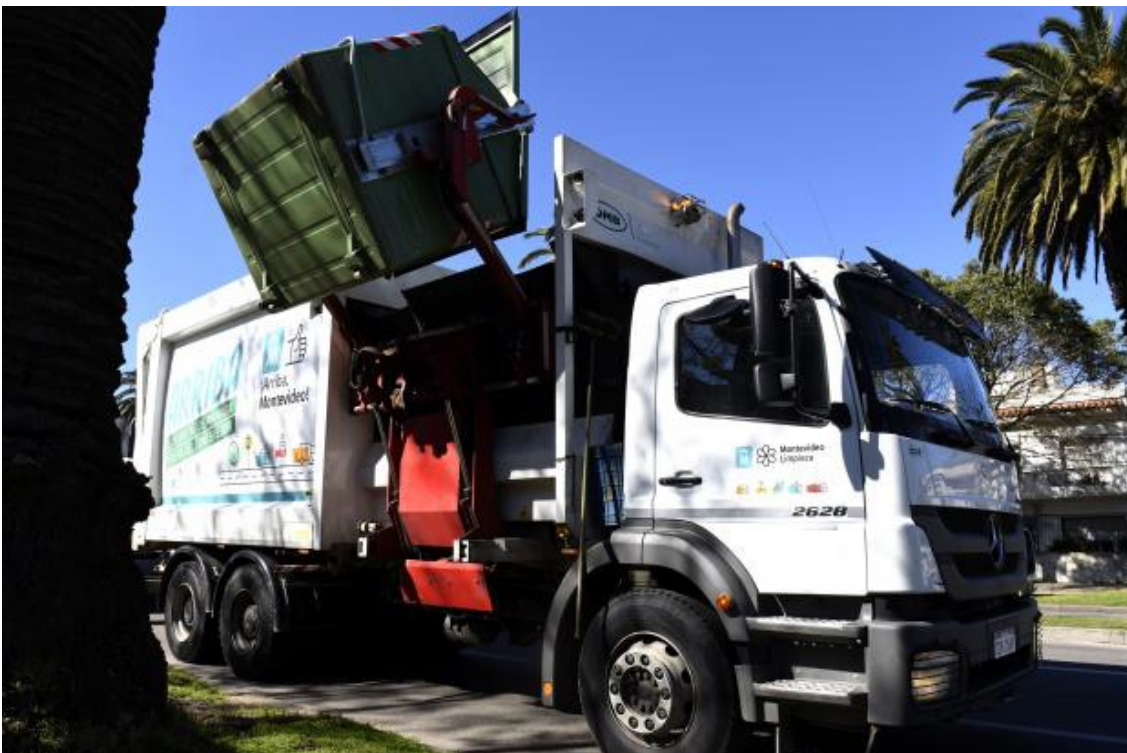
Fig. 11-13 Vaciado del contenido de un contenedor con residuos domiciliarios por inversión. [Ñ-13]
