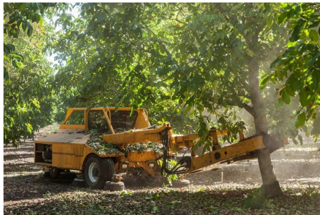
Fig. 2-18. Cosechadora de nogal con brazo vibrador que se vincula al tronco del árbol. [G-18]
