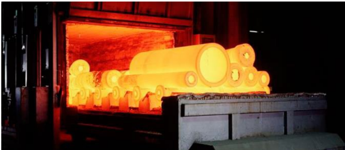
Fig. 13-16. Tubos de acero saliendo del horno de temple. [P-16]
