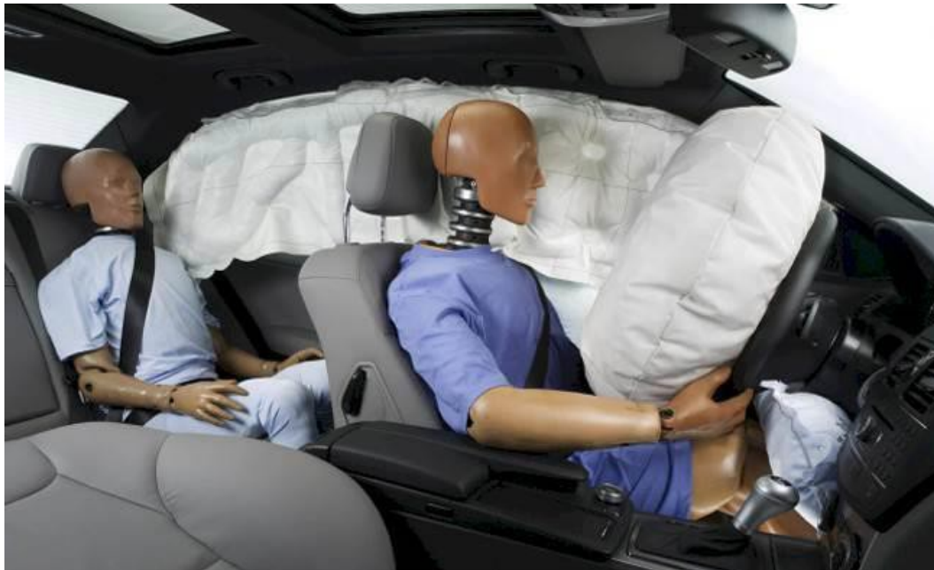
Fig. 7-11 Airbags frontales y laterales a la hora del impacto. [J-11]
