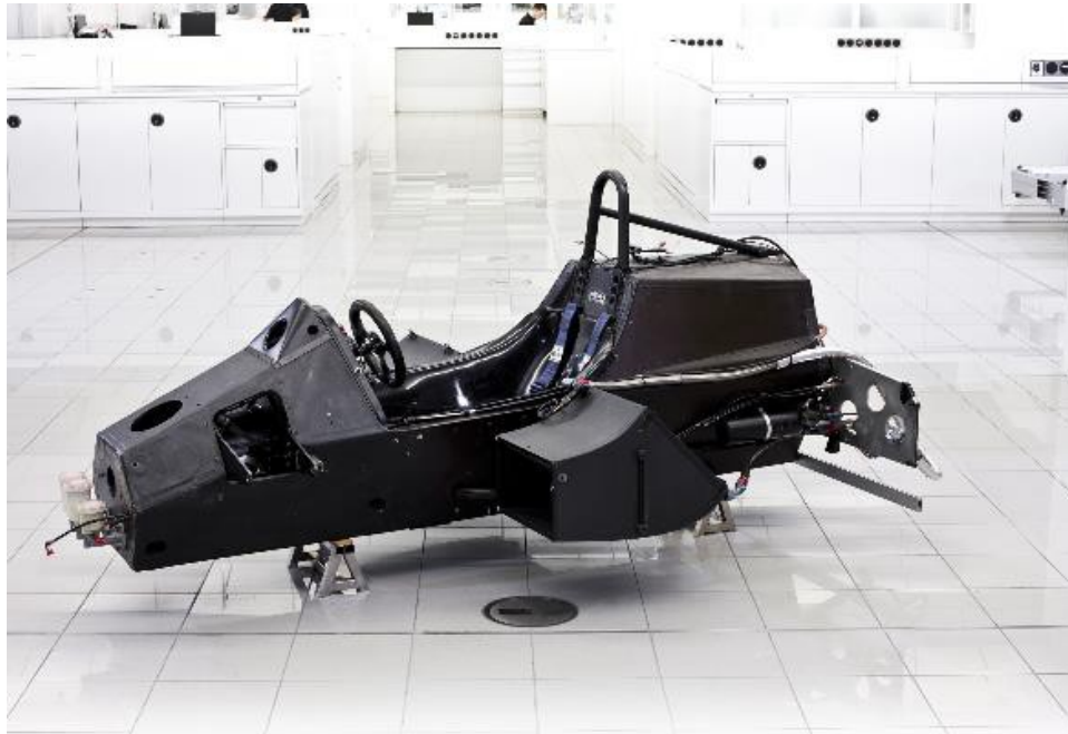
Fig. 2-30 Monocasco de Fórmula 1 fabricado con fibra de vidrio. [D-30]
