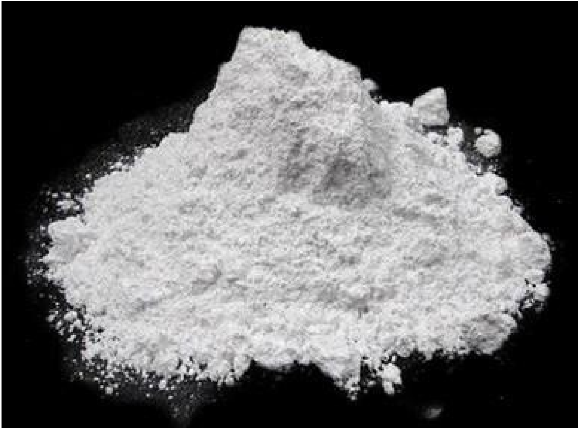
Fig. 4-39 El carbonato de calcio es una carga muy común en los polímeros, para aumentar rigidez y disminuir costo. [G-39]
