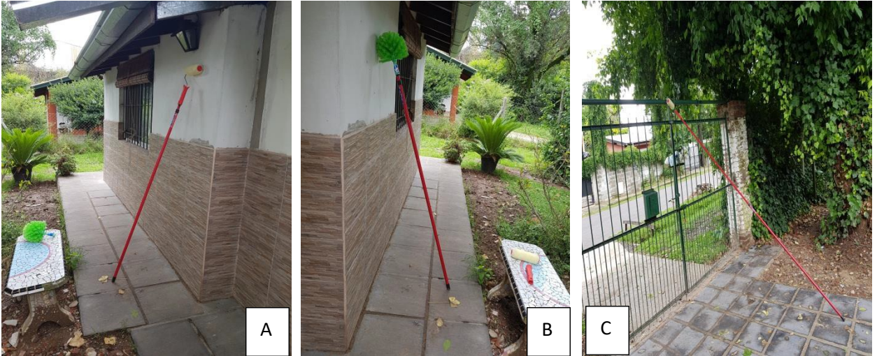
Fig. 22-7 Ejemplo de pértiga extensiva telescópica. A) pértiga sin extender con rollo para pintar B) Pértiga sin extender con plumero para limpieza C) pértiga extendida. Fotos del autor.
