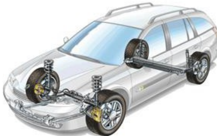
Fig. 1-11 Amortiguadores de automóviles delanteros y traseros adosados en la cara interna de cada una de las ruedas. [C-11]
