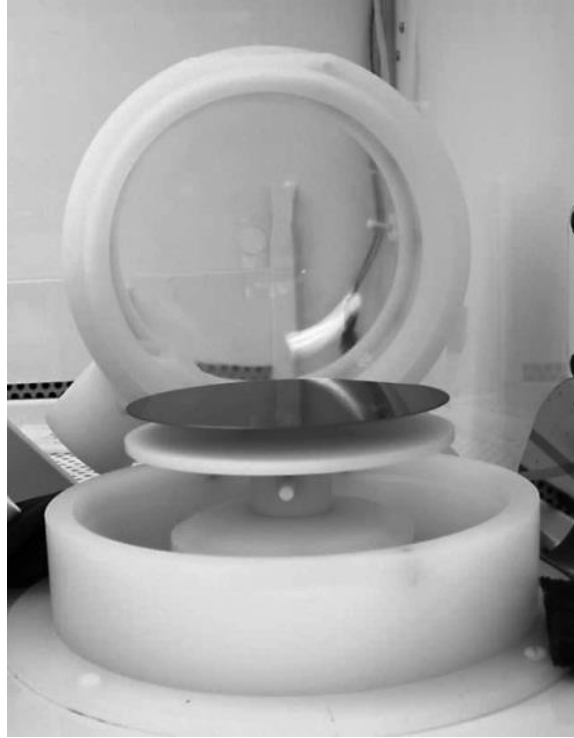
Fig. 5-16 Un spinner empleado para aplicar una capa fotosensible a la superficie de una oblea de silicio. [H-16]
