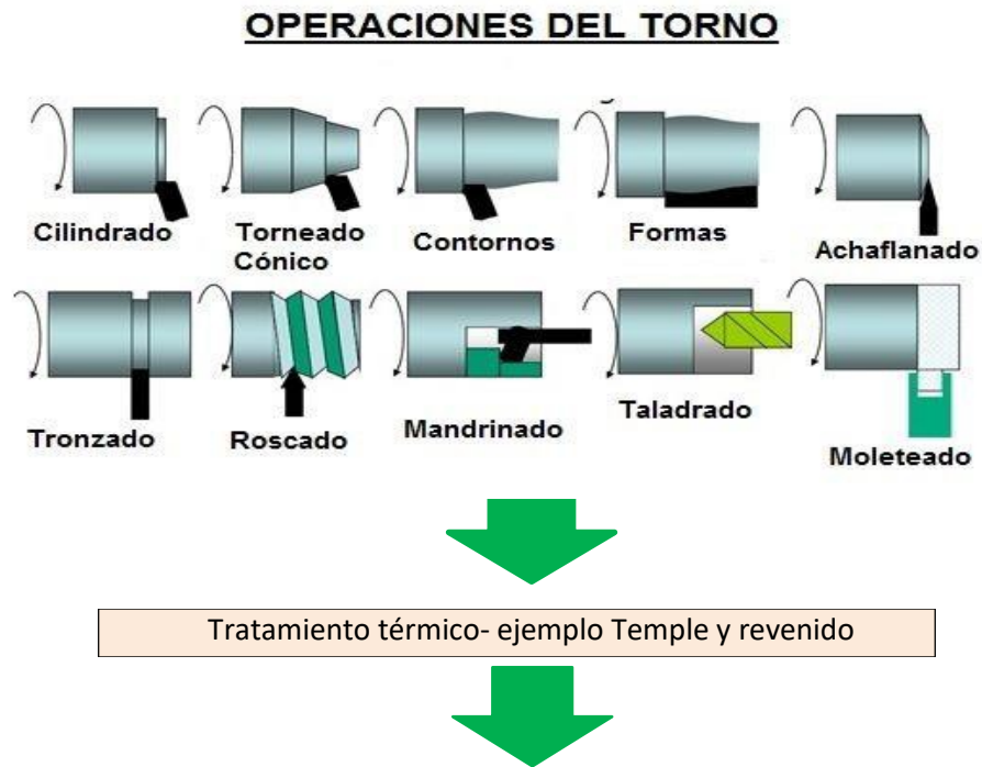
Fig. 10-16 Ejemplos de desbaste y terminación por medio del torneado mecánico. [L-16]
