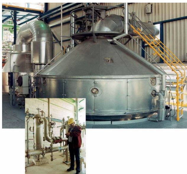
Fig. 4-38 Oxidación de amoníaco para la obtención de monóxido de nitrógeno. [G-38]
