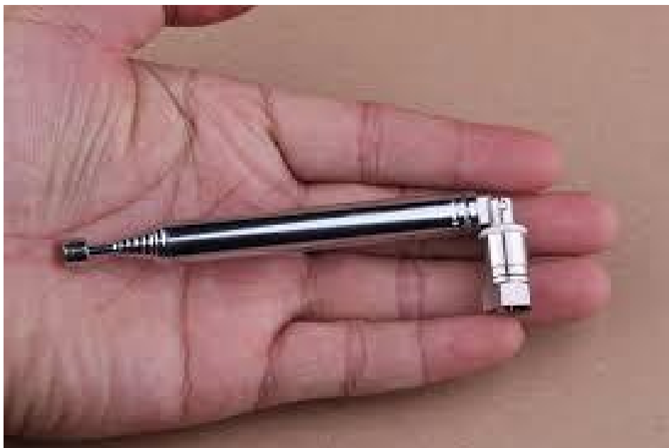
Fig. 15-7 Ejemplo de antena de radio telescópica. [X-7]
