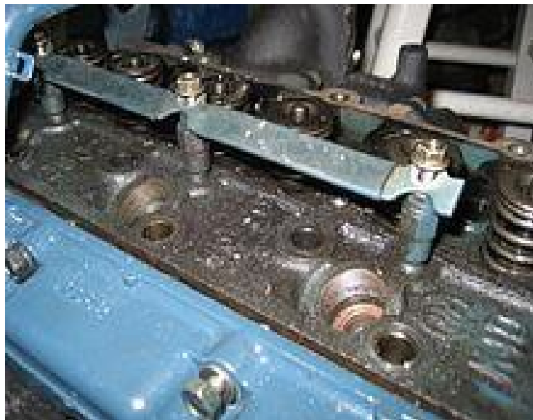
Fig. 6-10 Bujías de precalentamiento conectadas a la barra de contacto. [K-10]
