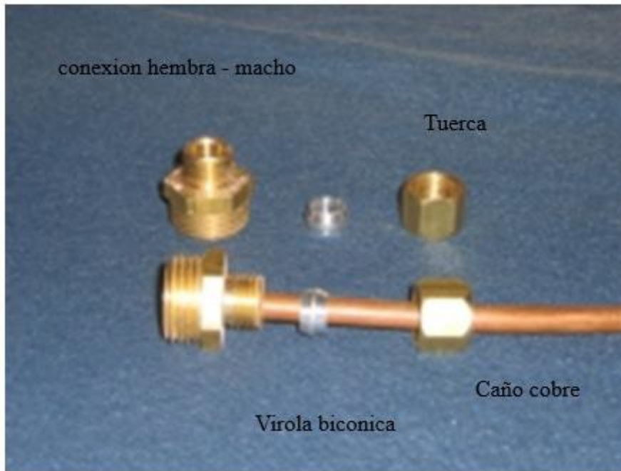
Fig. 6-24 Conexión caño de cobre en conexión macho-hembra mediante virola bicónica con tuerca. [F-24]
