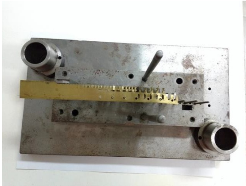
Fig. 16-16 Matriz abierta lado hembra con una tira de chapa con los distintos pasos necesarios. [Q-16]
