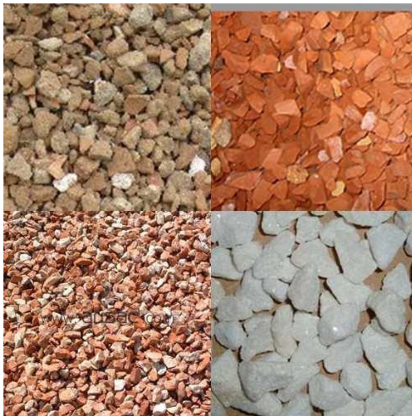
Fig. 3-39 Los áridos son todo el conjunto de materiales granulares derivados de la fragmentación de rocas y arenas. Generalmente son utilizados en la construcción de todo tipo de obras como: edificios, puentes, vías de comunicación etc. [F-39]
