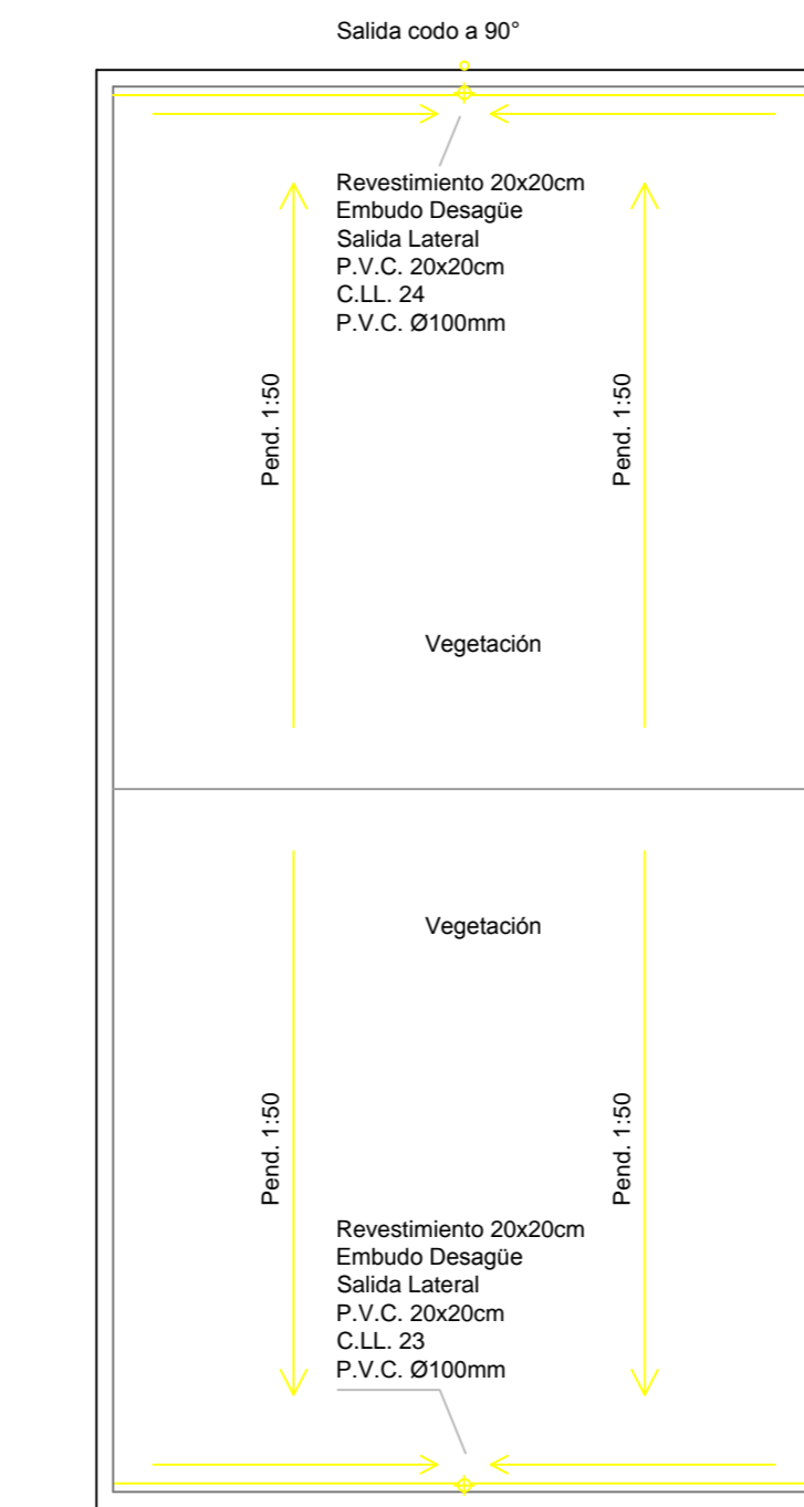
PLANTA DE TECHO S.U.M. - CANTINA - BAÑOS
