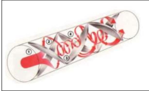
Figura 83. Funcionamiento de mezclador estático. Fuente: [www.novatecfs.com](http://www.novatecfs.com)
