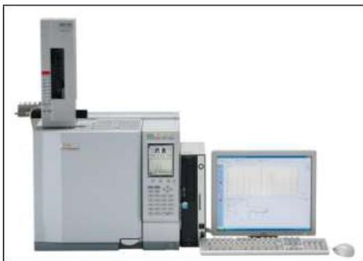
Figura 94. Cromatógrafo de gases. Fuente: [www.jenck.com](http://www.jenck.com)
