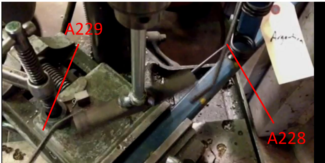
Fig. 3.31 a) Dispositivo de ensayo de dientes material A229 vs A228
