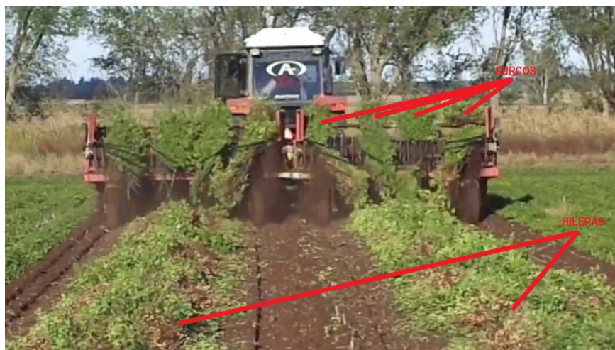
Fig. 1.5 Proceso de arrancado del maní, se agrupan 4 surcos en una hilera.
