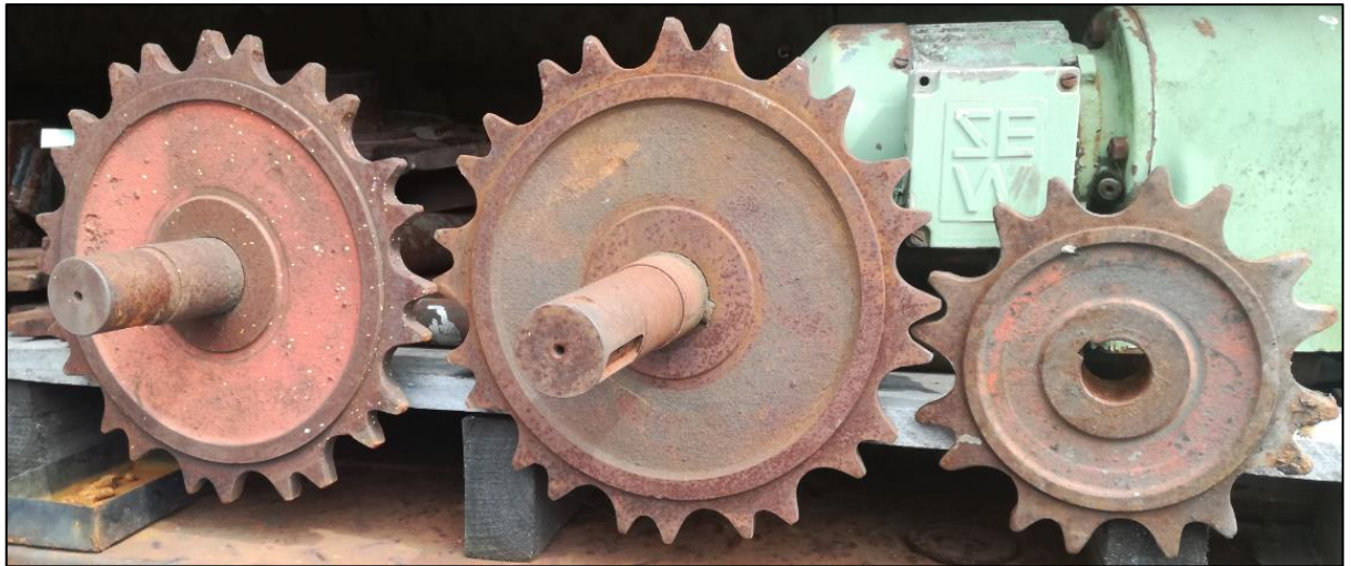
Figura 4.55: Foto de Ruedas Motrices y Conducidas, transportador CT6-3.
