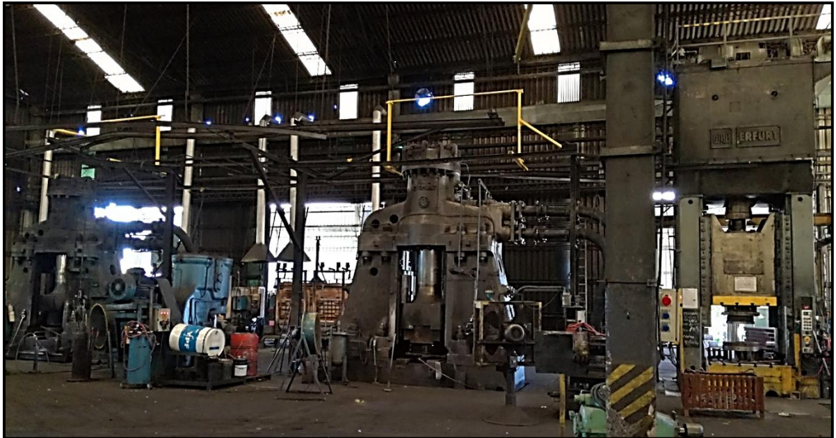
Figura 2.10: Martillos y prensas de la línea. De izquierda a derecha: Martillo de preforjado, Martillo de forjado y Prensa rebabadora.
