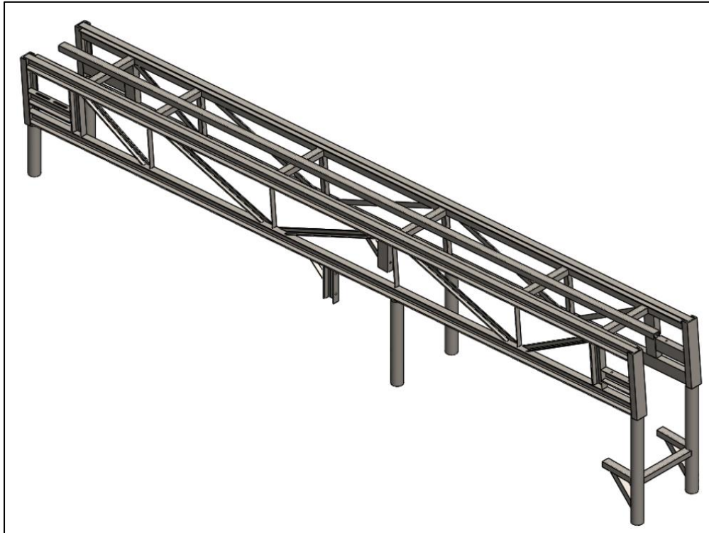
Figura 4.48: Estructura del transportador CT6-1.
