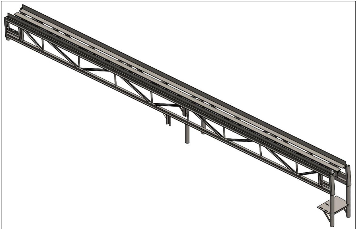
Figura 4.31: Estructura del transportador CT6-2
