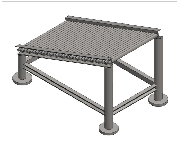
Figura 3.13: Propuesta de diseño de la rampa de rodillos RR6-3
