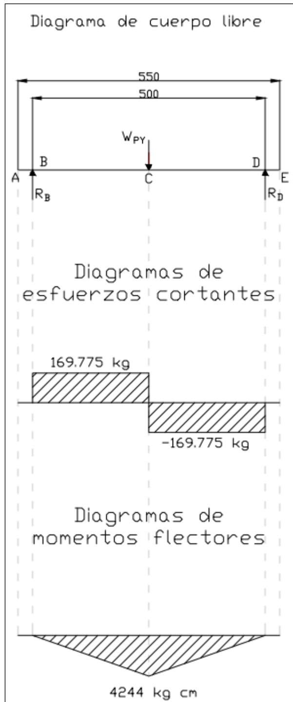
Figura 4.75: Diagrama de cuerpo libre, esfuerzos cortantes y momentos ejes fijos RR6-2.
