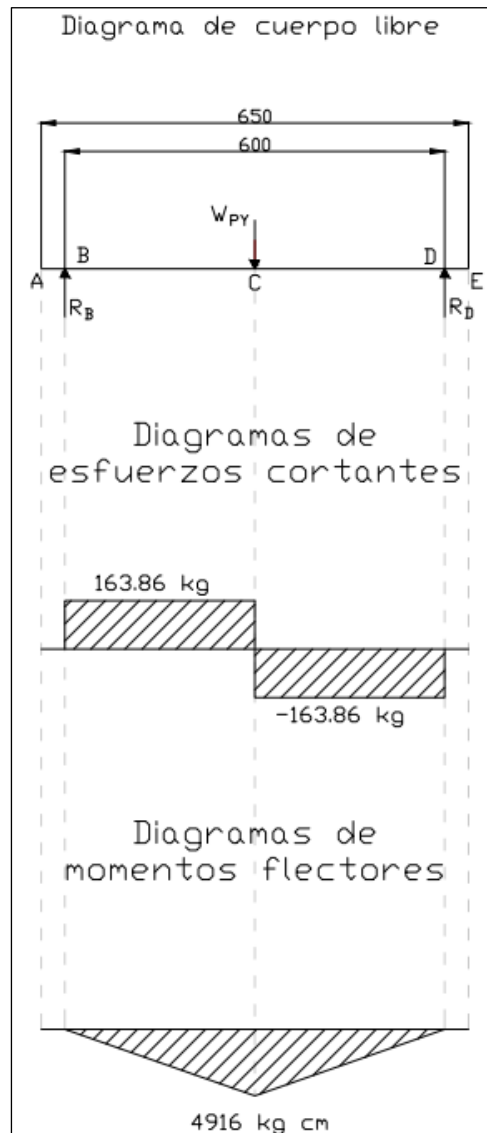
Figura 4.80: Diagrama de cuerpo libre, esfuerzos de corte y momentos flectores RR6-3.
