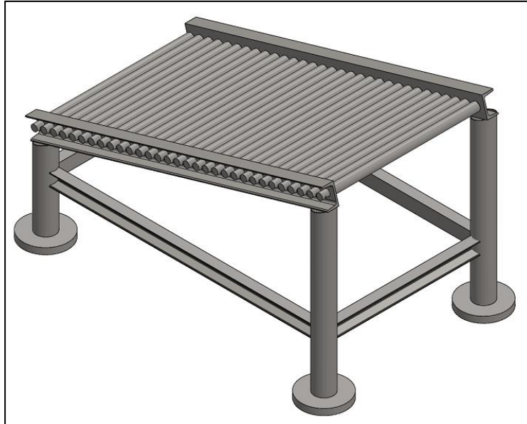
Figura 3.15: Propuesta de diseño de la rampa de rodillos RR6-4
