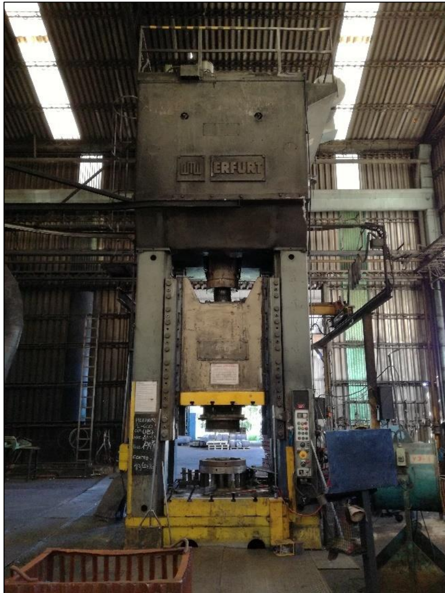
Figura 2.9: Prensa rebabadora de la línea 6.
