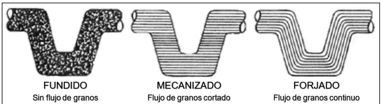
Figura 1.1: Disposición final de los granos para diferentes procesos de conformado de piezas.
