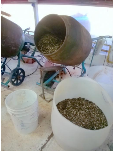
A. Hormigonera modificada
