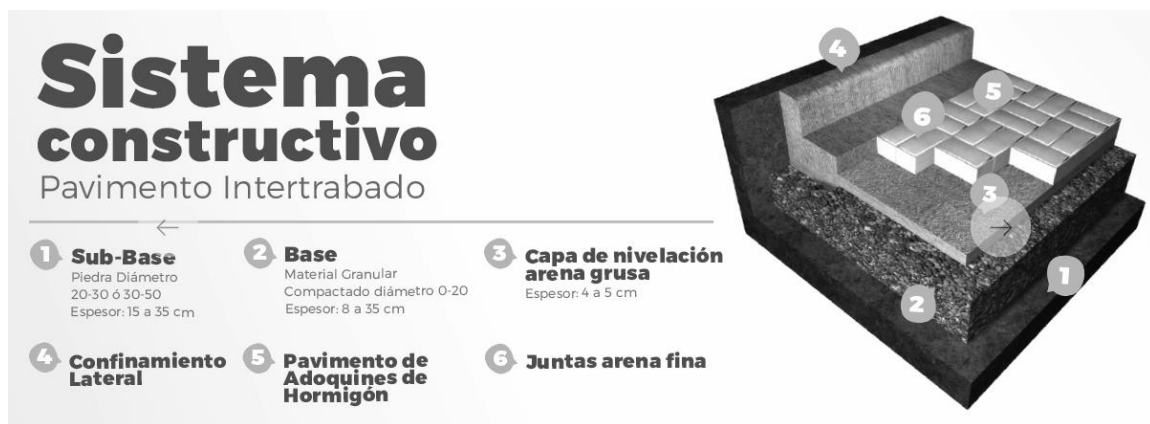
Figura 4- 5: Detalles de sistema constructivo adoquines intertrabados
