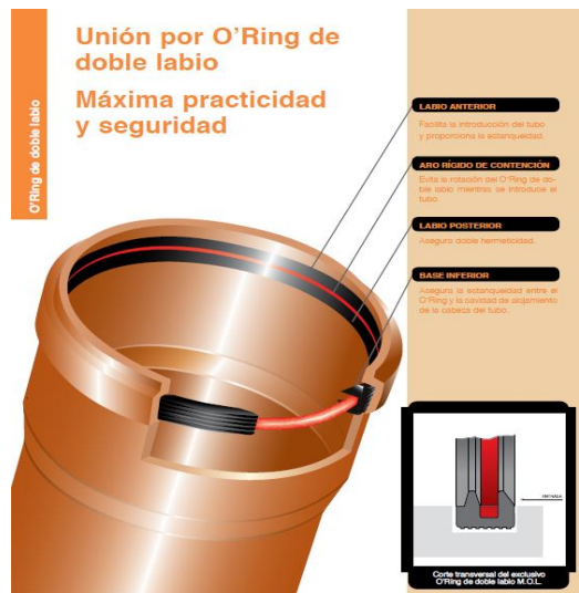
Figura 7- 31: Detalle unión por O'Ring de doble labio
