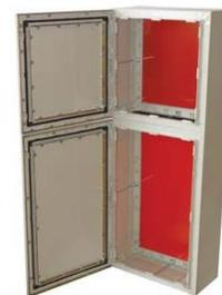
LOS GABINETES PUEDEN SER UNIDOS EN SUS LATERALES, LOS CUALES SON CALADOS PARA EL PASO DE CONDUCTORES Y BARRAS. PARA LOGRAR HERMETICIDAD EN LA UNIÓN DE GABINETES SE COLOCA UN BURLETE EN TODO SU PERÍMETRO. FINALMENTE SE FIJAN LOS LATERALES POR 8 BULONES. DE ESTA FORMA SE LOGRAN DIFERENTES PRESTACIONES SEGÚN AMERITE LA NECESIDAD. INCLUSO PERMITE QUITAR UN LATERAL DEL GABINETE INSTALADO, PERFORARLO Y ARMAR EN OBRA UNO O VARIOS GABINETES SEGÚN SEA LA APLICACIÓN.
