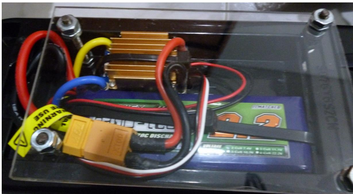
Figura 41: Montaje batería y ESC
