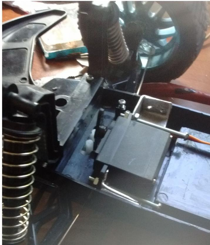
*Figura 3: Montaje Servo de Dirección*
