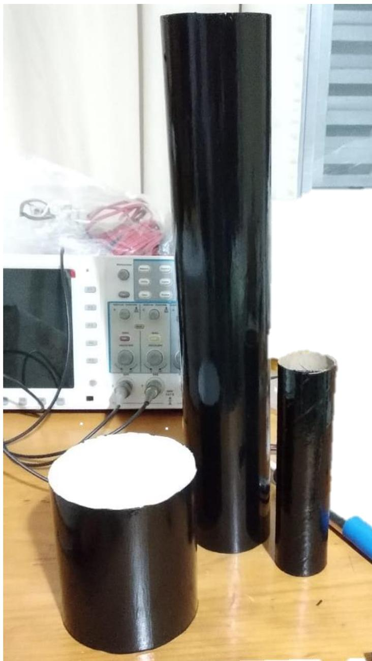
Figura 32 –Núcleos de las bobinas secundarias y primaria mayor.
