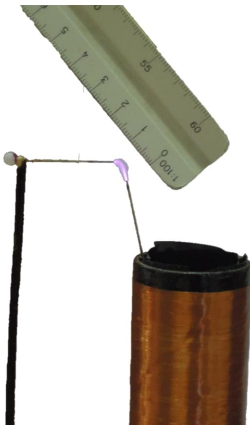
Figura 30 –Comparativa de chispa con escalímetro.
