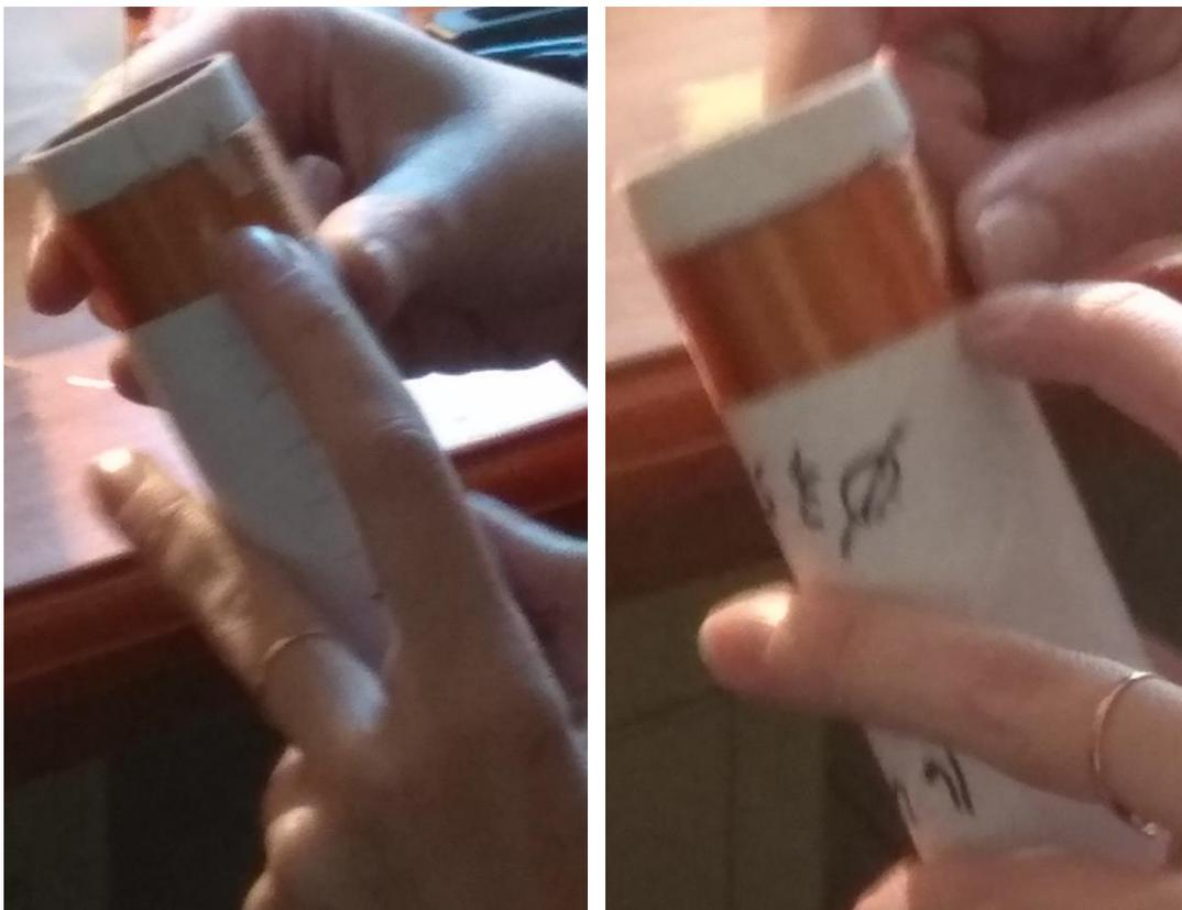
Figura 6 – Proceso de elaboración de la bobina prototipo.
