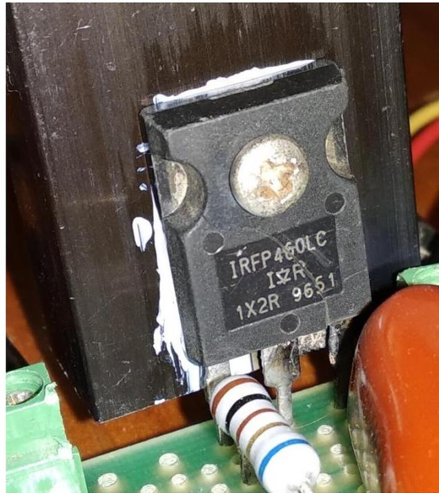
Figura 21 –MOSFET dañado por sobre corriente.
