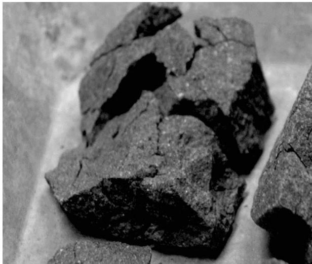
Figura 8. Muestra fisurada a 90 días. Primer ángulo.
