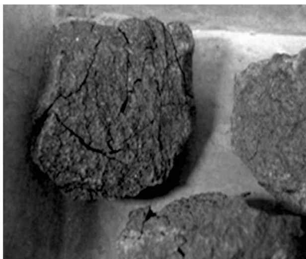
Figura 4. Muestra fisurada a 30 días. Primer ángulo.
