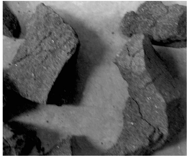
Figura 7. Muestra fisurada a 45 días. Segundo ángulo.
