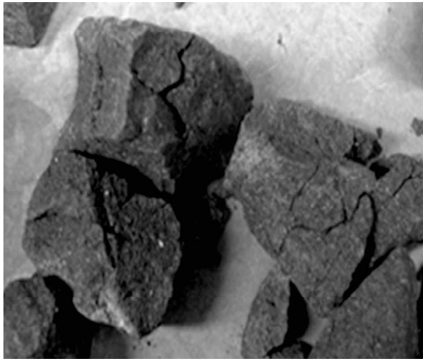
Figura 6. Muestra fisurada a 45 días. Primer ángulo.
