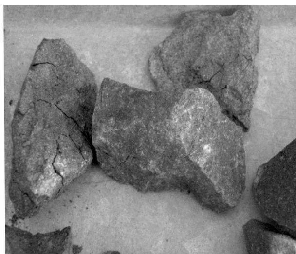
Figura 5. Muestra fisurada a 30 días. Segundo ángulo.
